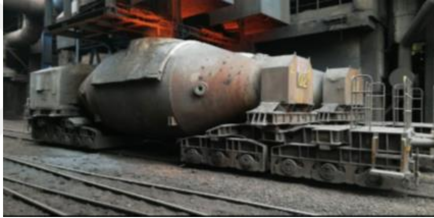
Şekil 2.3. Yüksek fırından döküm alan bir torpedo.
