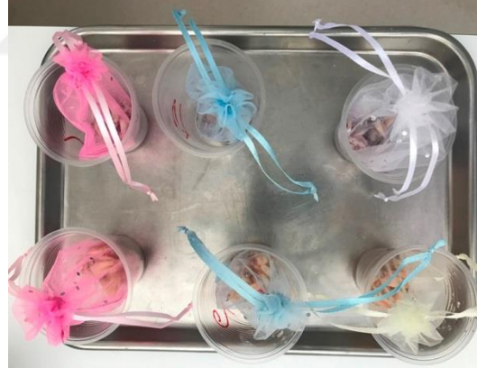
Şekil 17. Dişlerin termal döngü cihazında 5°C-55°C arasında termal döngü işlemine tabi tutulması
