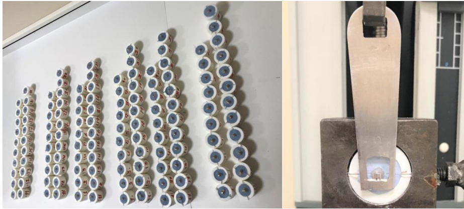
Şekil 19. a) Örnekleri kopma testi için hazırlanması b) Örneğin, kopma testi cihazına yerleştirilmesi.
