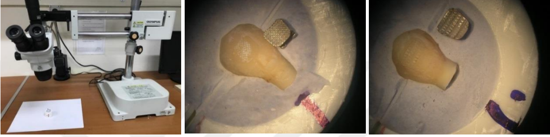
Şekil 20. Kopma testi sonrası Stereomikroskop görüntülerinin alınması.
