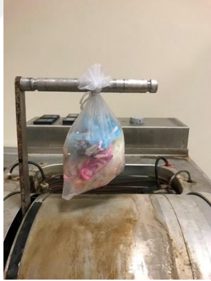
Şekil 17. Dişlerin termal döngü cihazında 5°C-55°C arasında termal döngü işlemine tabi tutulması
