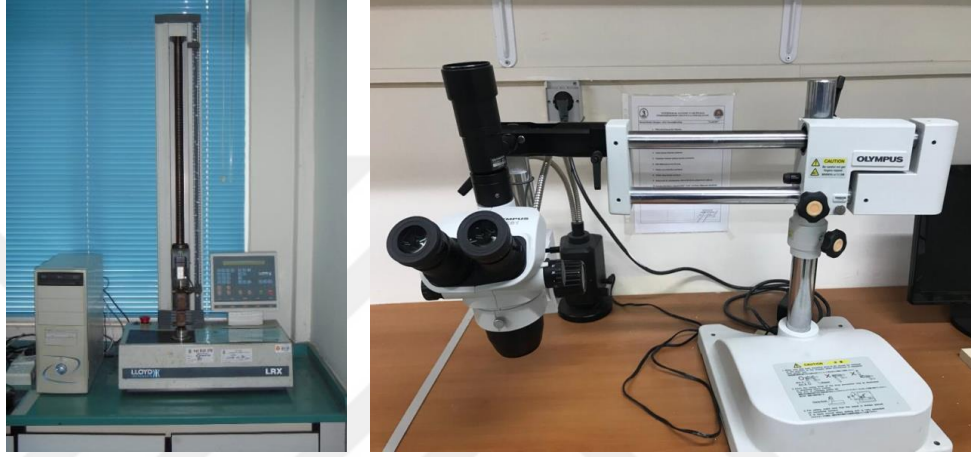
Şekil 6. a) Lloyd Instruments makaslama bağlanma dayanımı test cihazı b) OLYMPUS Stereo-mikroskop.
