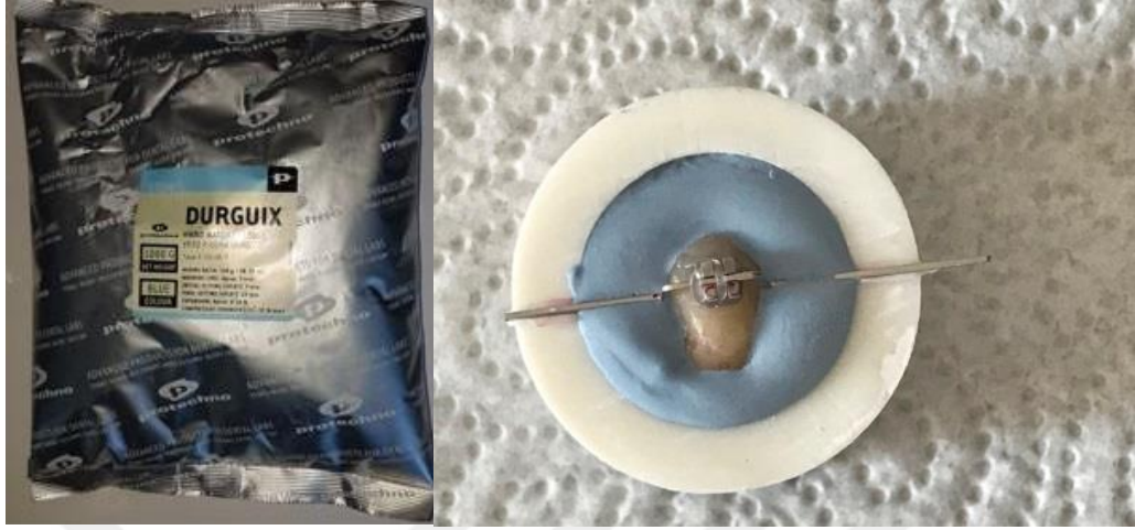
Şekil 18. Örneklerin Alçı Bloklara Gömülmesi
