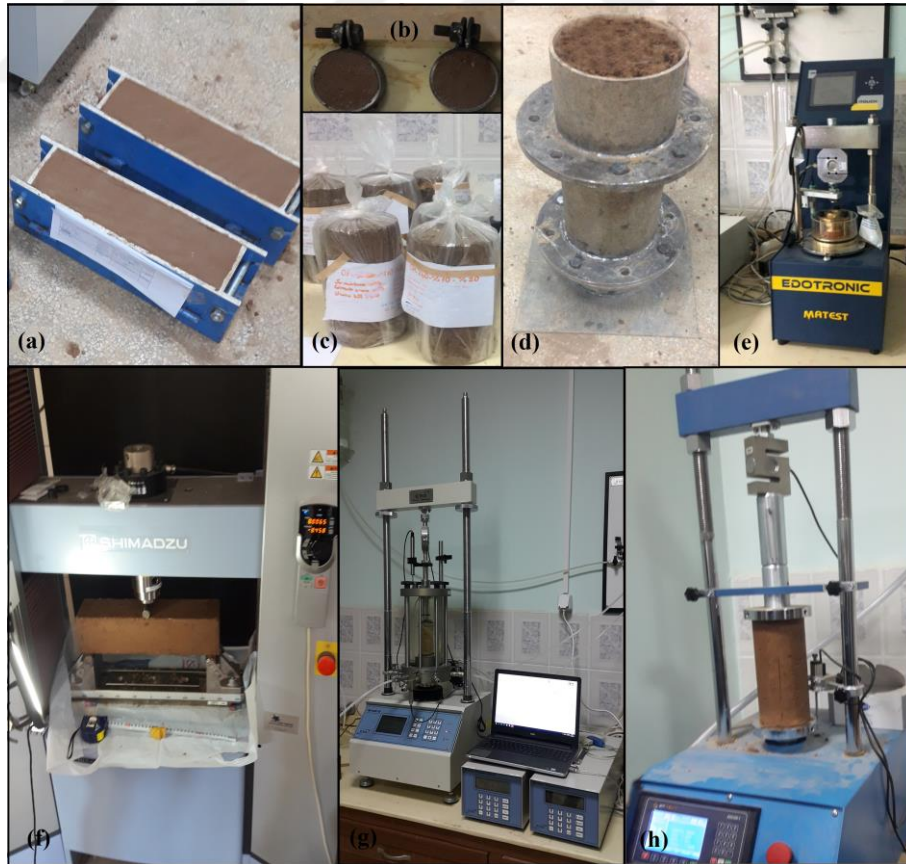
Şekil 3.11. Elyaf katkılı karışımlar için numune hazırlama prosedürü ve deneyler
