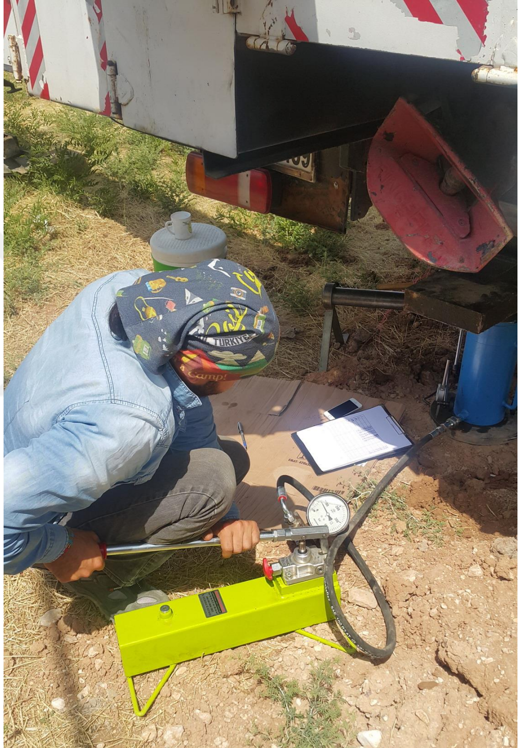
Şekil 3.29. DKK üzerine yük aktarma işlemi
