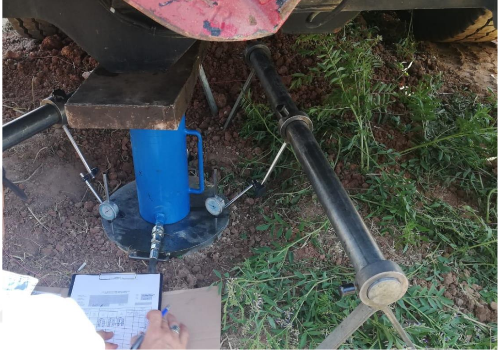
Şekil 3.30. Yüklemeye testinde verilerin forma aktarılması
