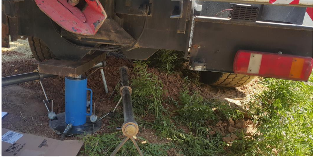
Şekil 3.27. Yüklemeye testinde kullanılan deformasyon saatleri
