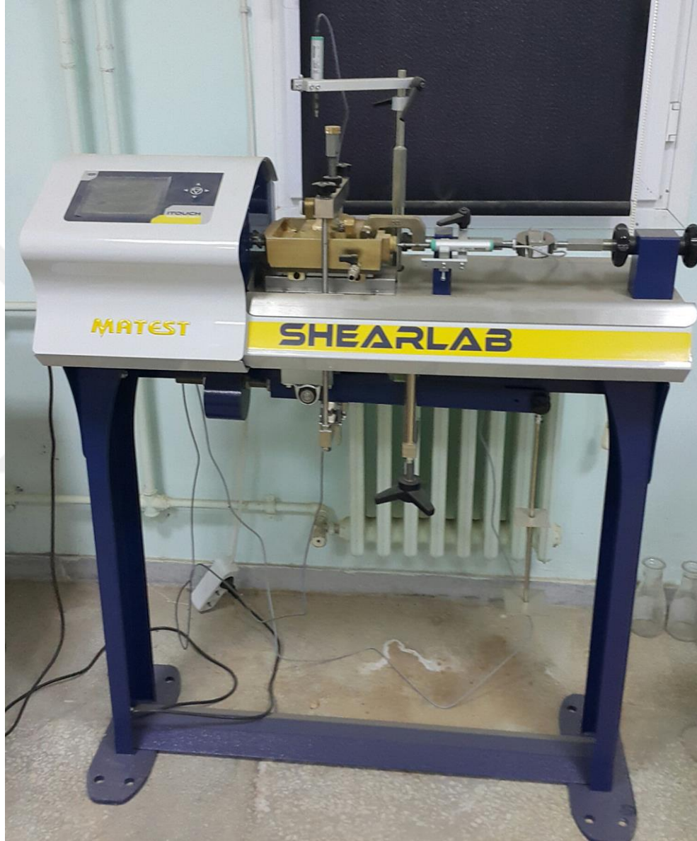
Şekil 3.33. Yarı otomatik dijital direkt kesme kutusu test cihazı
