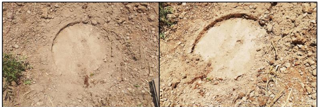
Şekil 3.31. DKK'ların deformasyon biçimi
