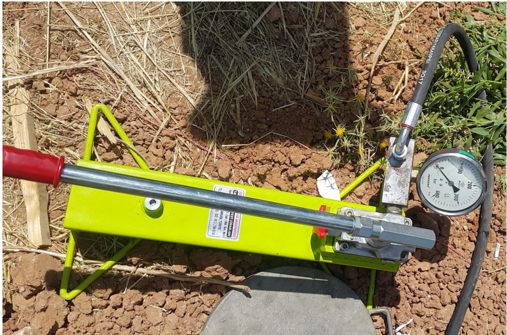
Şekil 3.28. Yüklemeye testinde kullanılan basınç göstergesi
