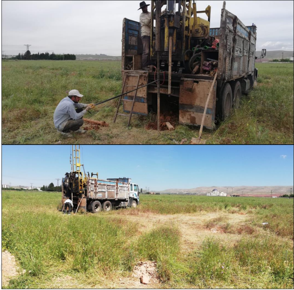
Şekil 3.19. Standart penetrasyon testi (SPT)
