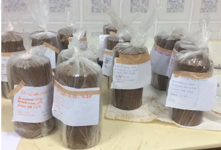
Şekil 3.7. Numuneleri kütleme aşaması
