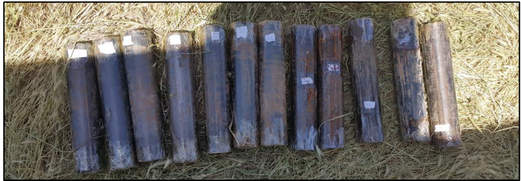
Şekil 3.20. Sondaj noktalarından alınan örselenmemiş numuneler
