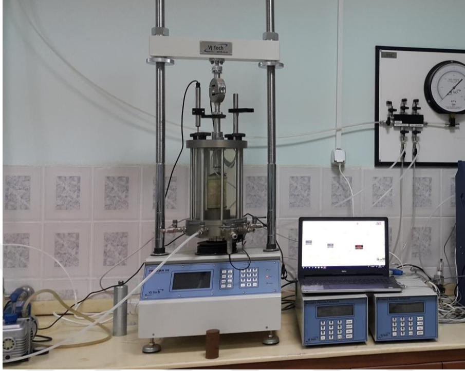
Şekil 3.9. Üretilen numuneler üzerinde gerçekleştirilen üç eksenli deneyi
