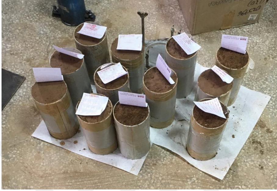
Şekil 3.6. Numuneleri kalıplama aşaması
