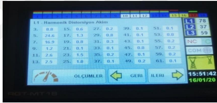
Şekil 6.7 : Tesise ait harmonik distorsiyon akımı değerleri (tek harmonikler).
