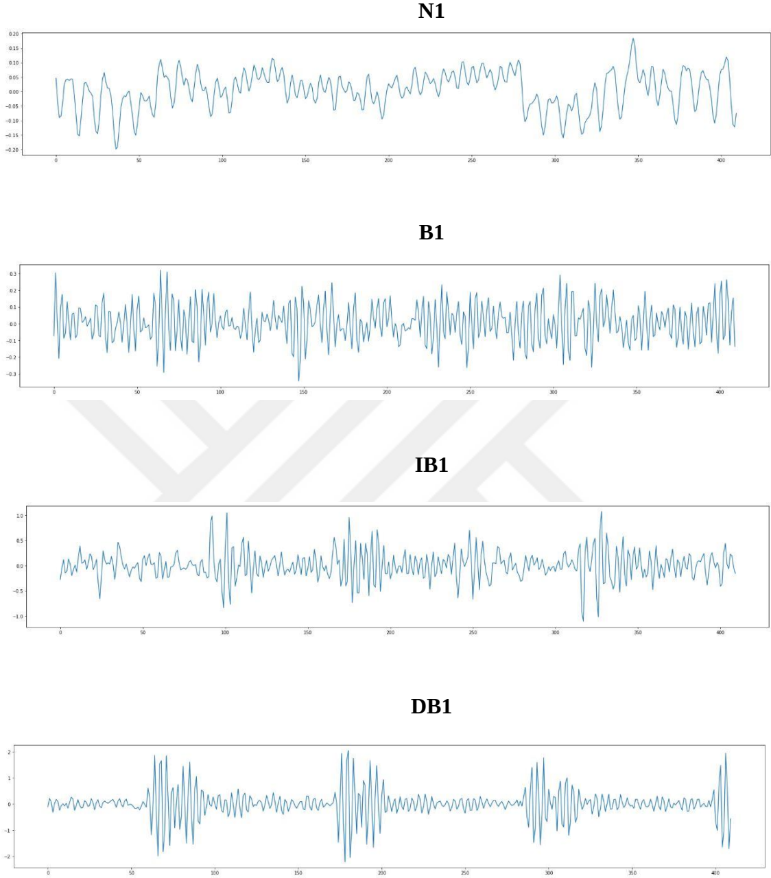
Şekil 12: 1 HP Motor Yüğü 1772 dev/dak için zaman etki alanı titreşim sinyalleri
