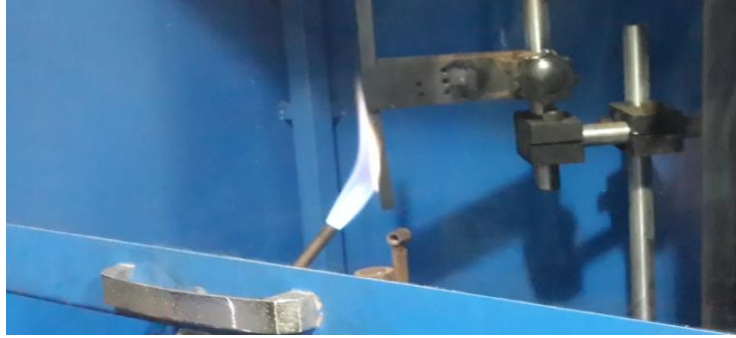
Resim 3.18 Alev alma karakteristiği testi 1.
