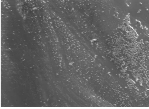
Resim 17. SEM’de FELDS Polisaj 500* ve 1000* görüntüsü
