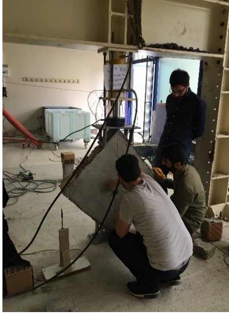
Resim 5.50. a) Çift yüzü Tür 2 ile güçlendirilmiş 2. tuğla duvarın diyagonal yükleme deneyine hazırlanması
