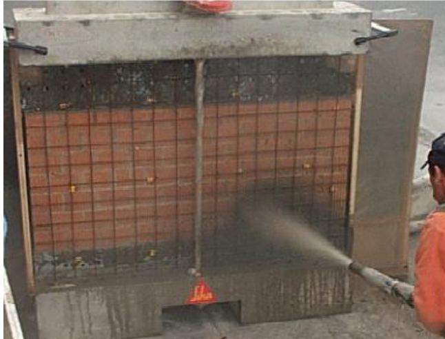
Resim 3.11. Püskürtme betonun numuneye uygulanması (Elgawady, Lestuzzi ve Badoux, 2006)
