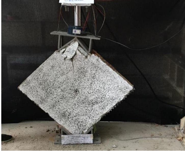
Resim 5.46. Diagonal yükleme sonrası çift yüzü Tür 2 ile güçlendirilmiş 1. tuğla duvar numunesinin ön yüzü
