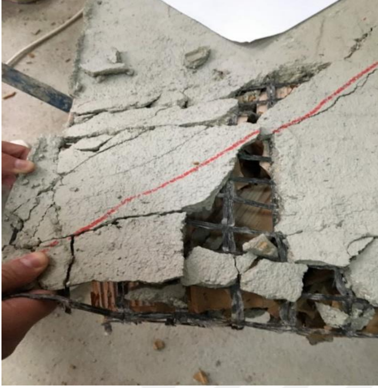
Resim 5.42. d) Diyagonal yükleme sonrası çift yüzü Tür 1 ile güçlendirilmiş 2. tuğla duvar numunesi
