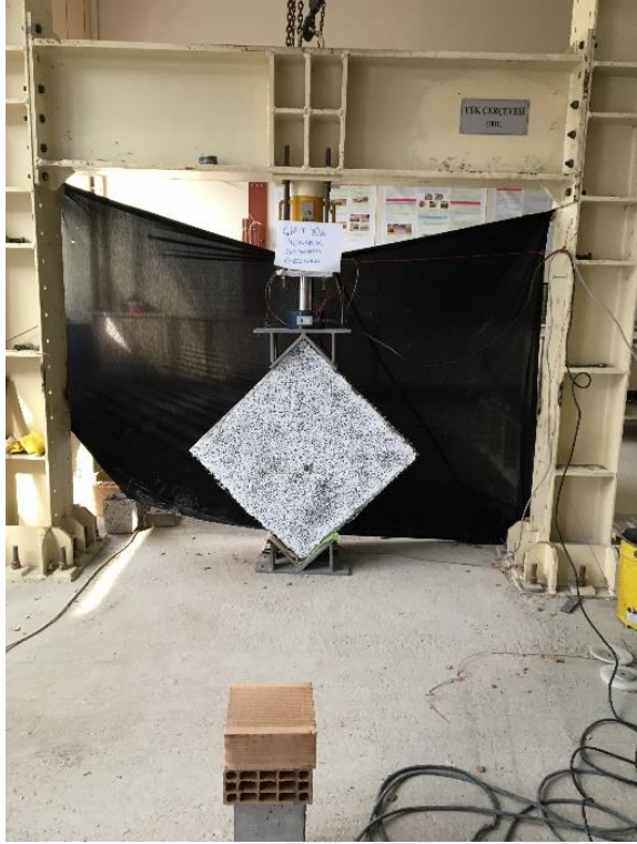
Resim 5.51. Diyagonal yükleme deneyine hazır çift yüzü Tür 2 ile güçlendirilmiş 2. Tuğla numunesinin ön yüzü
