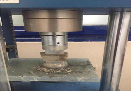
Resim 4.12. Basınç dayanımının ölçülmesi için numunenin deney düzeneğine yerleştirilmesi
