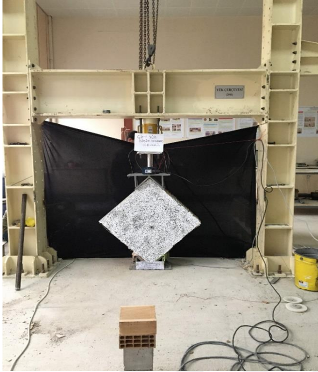
Resim 5.39. Diyagonal yükleme deneyine hazır çift yüzü Tür 1 ile güçlendirilmiş 2. Tuğla duvar numunesinin ön yüzü
