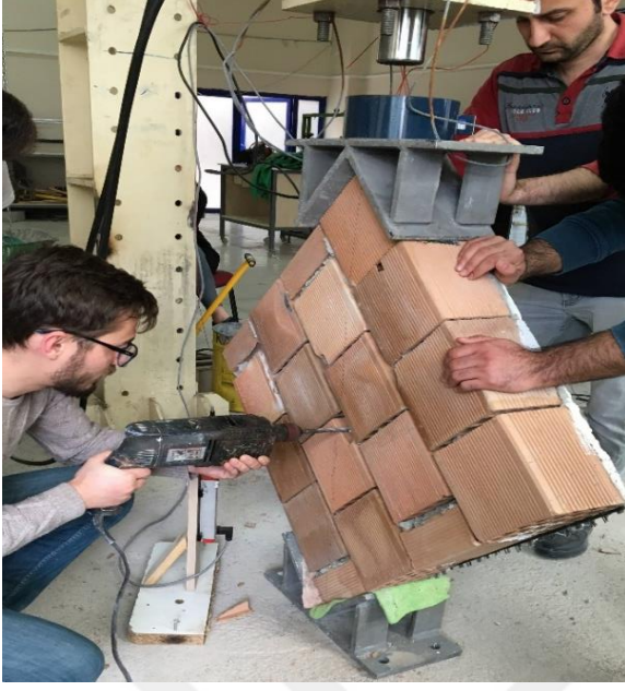
Resim 4.28. Tuğla duvarın matkapla delinmesi
