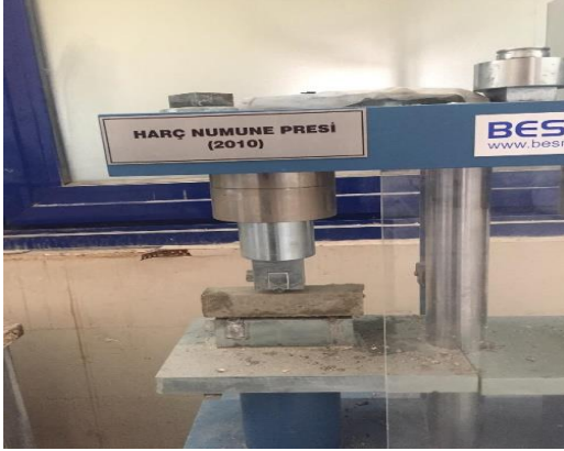
Resim 4.11. Eğilme dayanımının ölçülmesi için numunenin deney düzeneğine yerleştirilmesi
