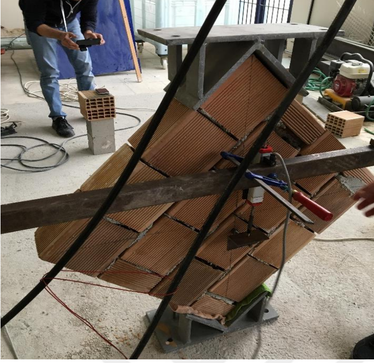
Resim 5.3. Diyagonal yükleme deneyine hazır şahit numunenin arka yüzü
