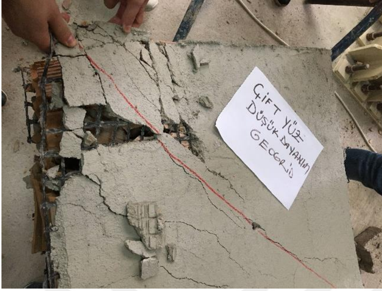
Resim 5.42. b) Diagonal yükleme sonrası çift yüzü Tür 1 ile güçlendirilmiş 2. tuğla duvar numunesi
