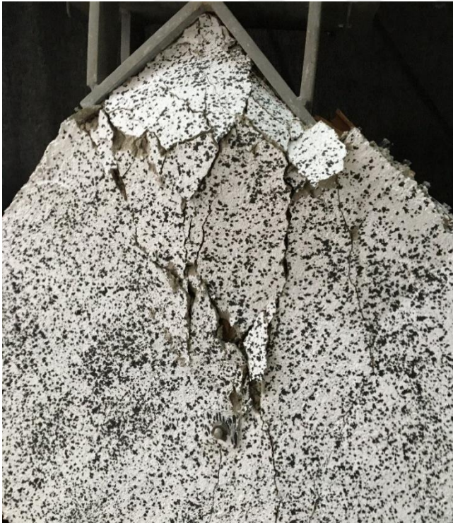
Resim 5.40. d) Diagonal yükleme sonrası çift yüzü Tür 1 ile güçlendirilmiş 2. tuğla duvar numunesinin ön yüzü
