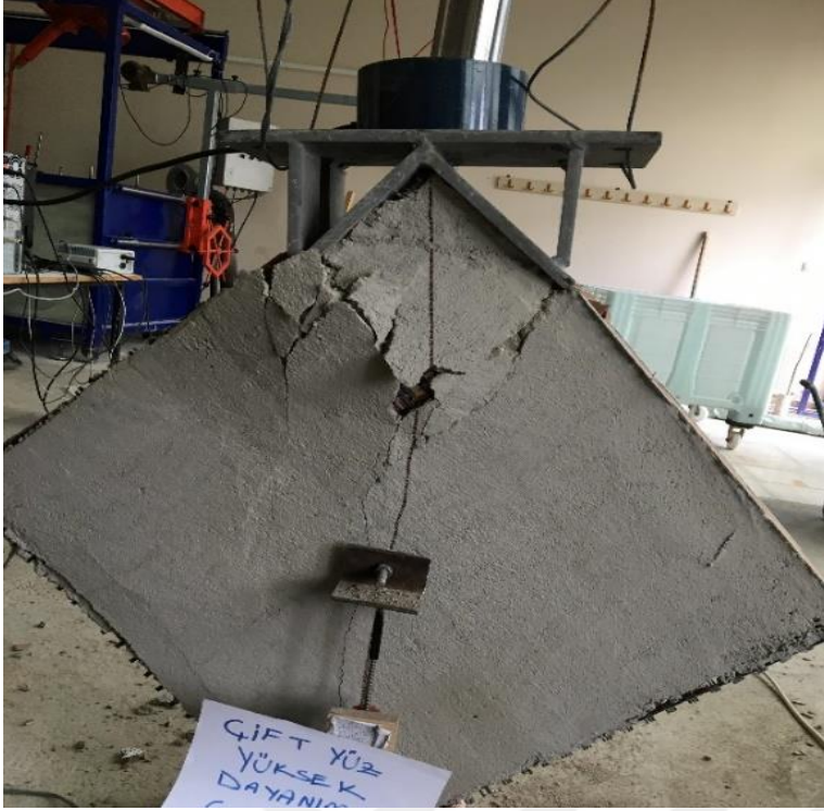
Resim 5.47. b) Diagonal yükleme sonrası çift yüzü Tür 2 ile güçlendirilmiş 1. tuğla duvar numunesinin arka yüzü
