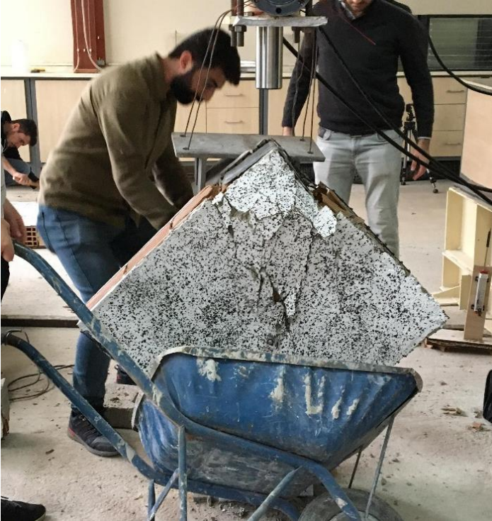
Resim 5.42. a) Diagonal yüklemeye sonrası çift yüzü Tür 1 ile güçlendirilmiş 2. tuğla duvar numunesi
