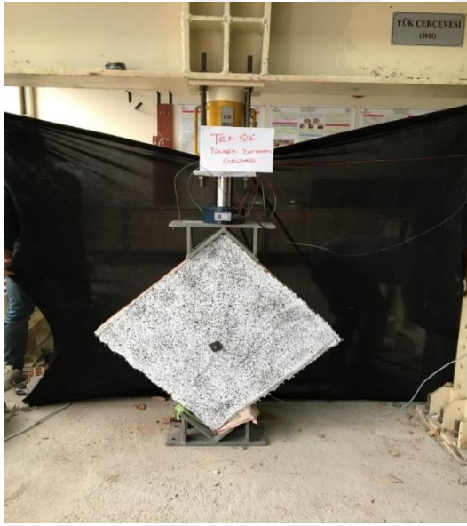
Resim 5.19. Diagonal yükleme deneyine hazır tek yüzü Tür 2 ile güçlendirilmiş 1. tuğla duvar numunesinin ön yüzü
