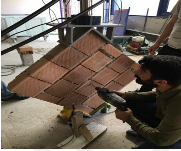
Resim 5.23. Tek yüzü Tür 2 ile güçlendirilmiş 2. tuğla duvar numunesinin diyagonal yükleme deneyine hazırlanması
