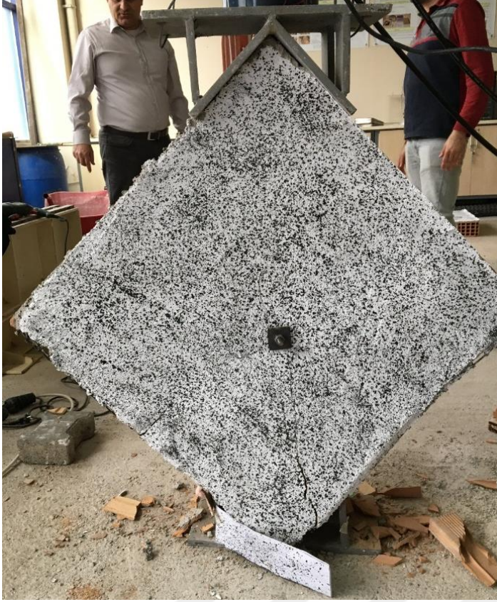
Resim 5.10. Diyagonal yükleme deneyi sonrasında tek yüzü Tür 1 ile güçlendirilmiş 1. numunenin ön yüzü
