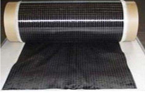
Resim 3.4. Deneyler için kullanılan CFRP malzeme (Coza, 2009)
