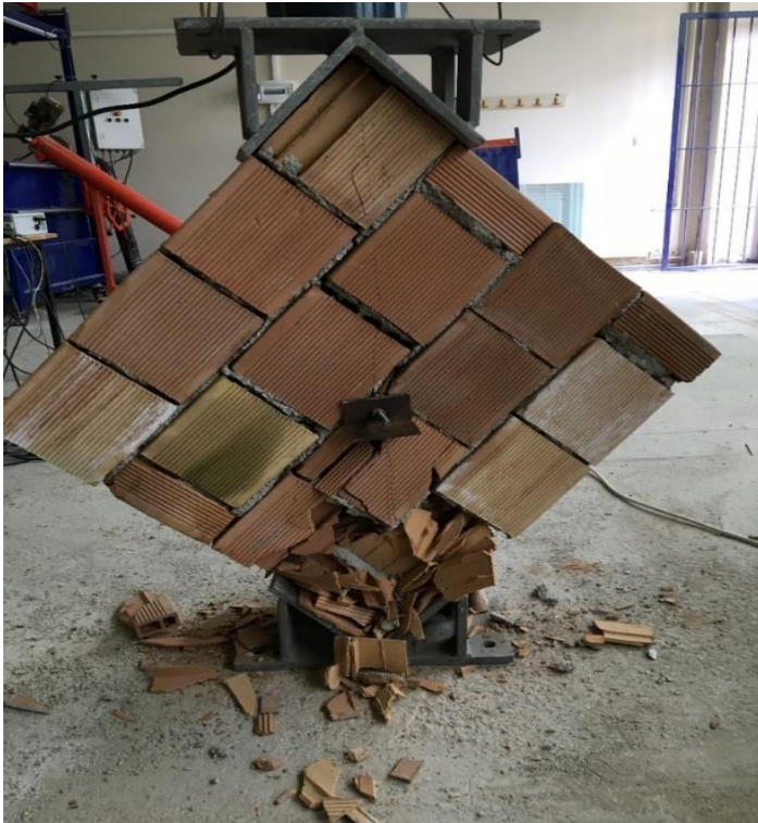
Resim 5.11. Diyagonal yükleme deneyi sonrasında tek yüzü Tür 1 ile güçlendirilmiş 1. numunenin arka yüzünde oluşan hasarlar
