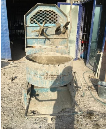
Resim 4.6. 27 dm 3 hacmindeki mikser
