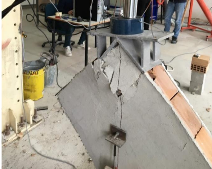
Resim 5.47. a) Diagonal yükleme sonrası çift yüzü Tür 2 ile güçlendirilmiş 1. tuğla duvar numunesinin arka yüzü
