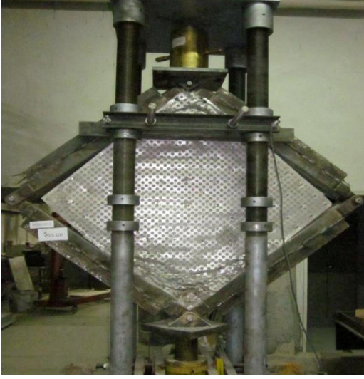
Resim 3.15. Delikli çelik levha ile güçlendirilmiş numunenin yükleme sonrası durumu (Seydanlıoğlu, 2013)
