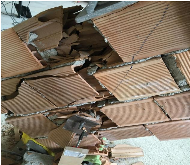
Resim 5.28. b) Diyagonal yükleme deneyi sonrası tek yüzü Tür 2 ile güçlendirilmiş 2. Tuğla duvar numunesinin arka yüzünde oluşan hasarlar
