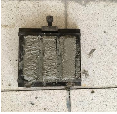
Resim 4.10. Kalıba yerleştirilmiş derz harcı
