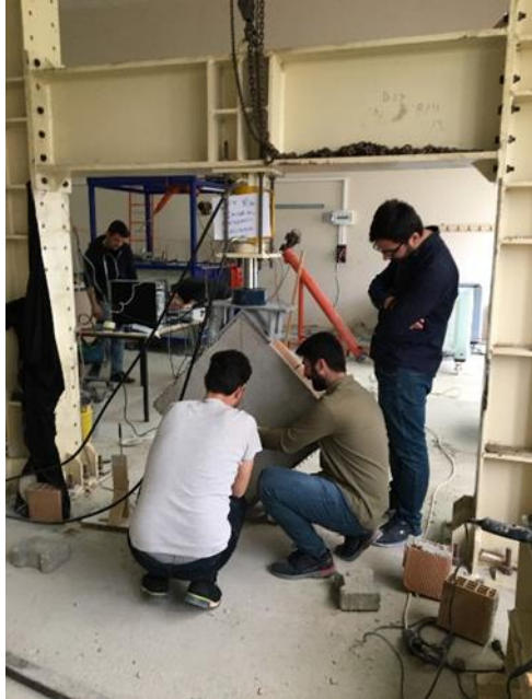
Resim 5.50. b) Çift yüzü Tür 2 ile güçlendirilmiş 2. tuğla duvarın diyagonal yükleme deneyine hazırlanması
