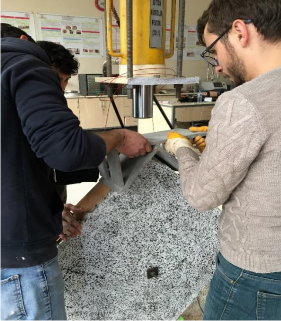
Resim 5.5. c) Tek yüzü Tür 1 ile güçlendirilmiş 1. tuğla duvarın diyagonal yükleme deneyine hazırlanması
