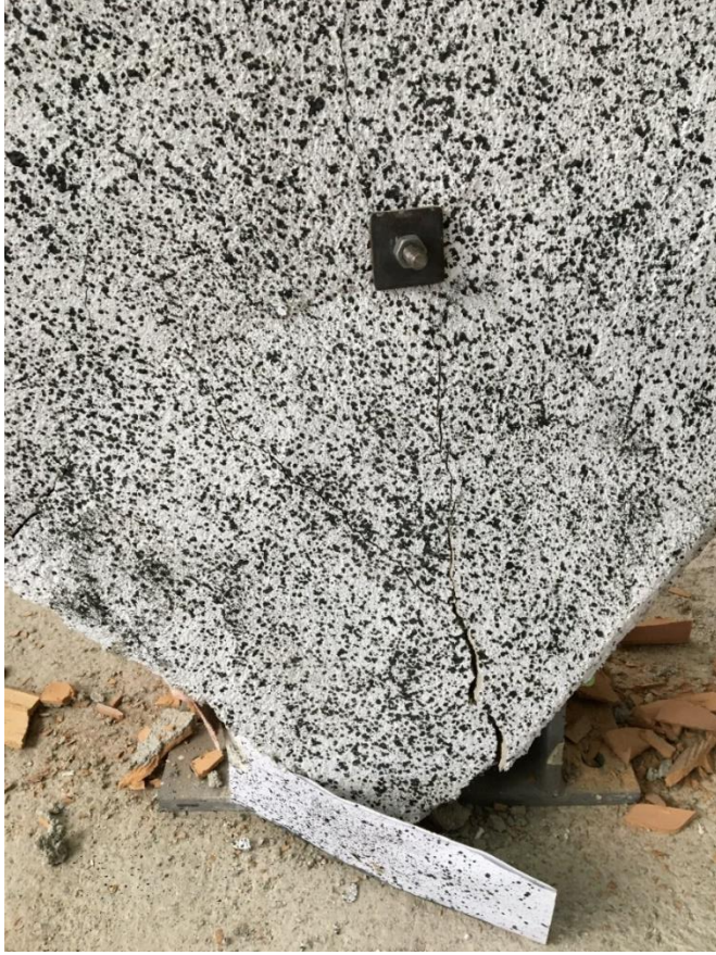
Resim 5.8. Diagonal yükleme deneyi sonrasında tek yüzü Tür 1 ile güçlendirilmiş 1. numunenin ön yüzünde oluşan kılcal çatlaklar
