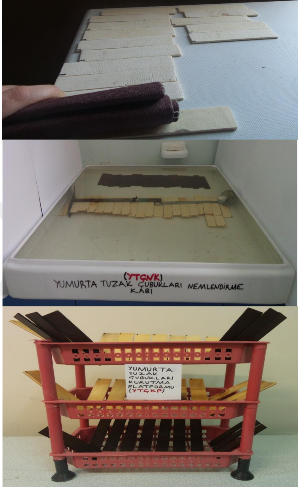
Şekil 3.8. Şeritlerin hazırlanması (yukarıdan aşağıya; zımparalama, nemlendirme, kurutma)
