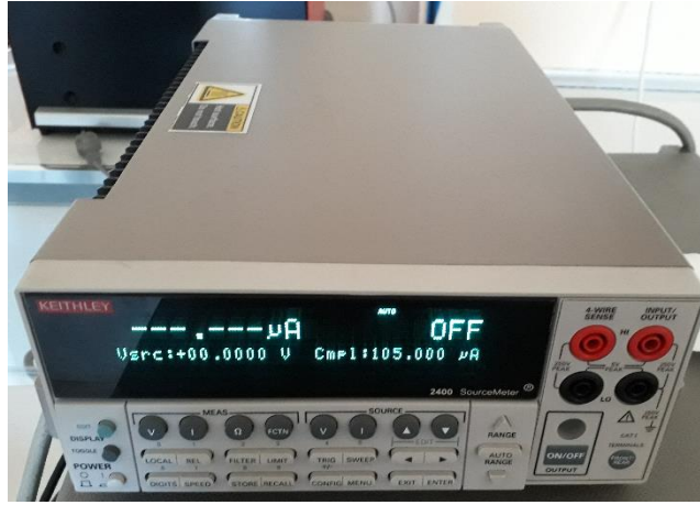
Şekil 3.2 Akım-voltaj ölçümlerinde kullanılan KEiTLEY 2400 cihazı
