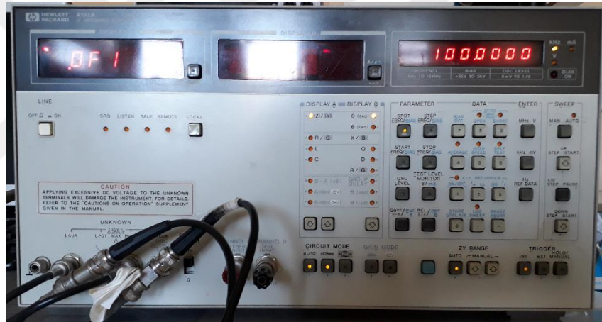
Şekil 3.3 Kapasite-voltaj ölçümlerinde kullanılan HEWLET PACKART 4192 A cihazı.
