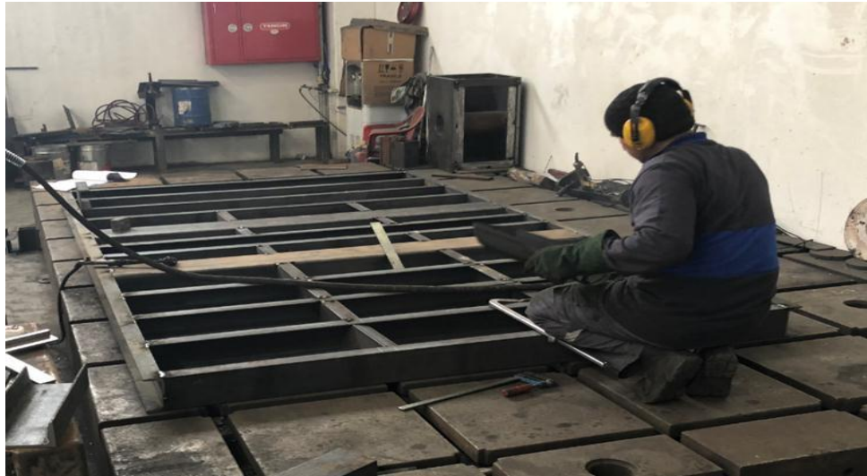
Şekil 3.55. Sehpa profillerinin kaynak işlemi
