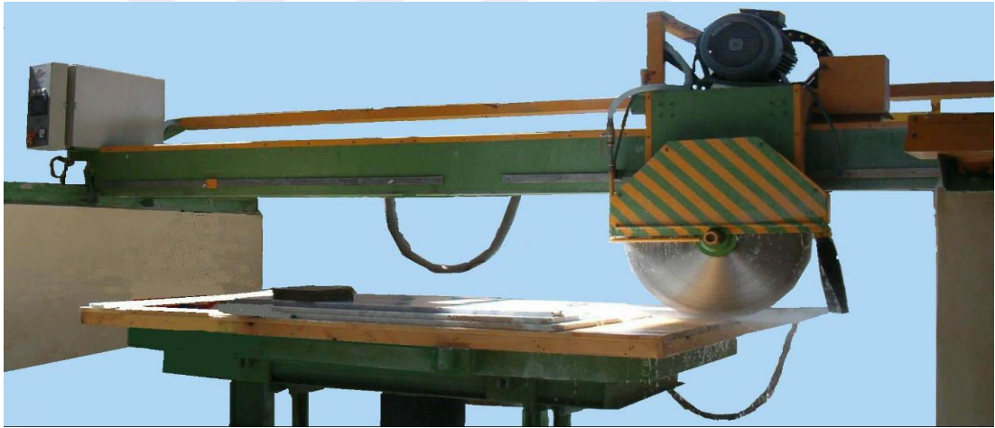
řekil 1.6. Elmas soketli dairesele mermer kesme testeresi (Eriřim tarihi: 19.03.2018. http://www.cihanmakmer.com )
