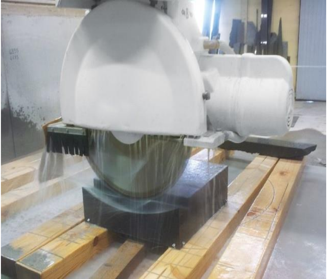
Şekil 4.7. 5 eksen makine prototipi ile parça işlenirken
