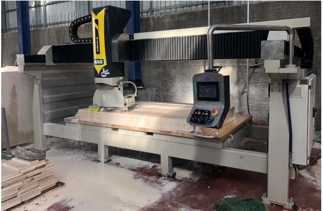
Şekil 4.3. İlk prototip – Çoklu kesim esnasında
