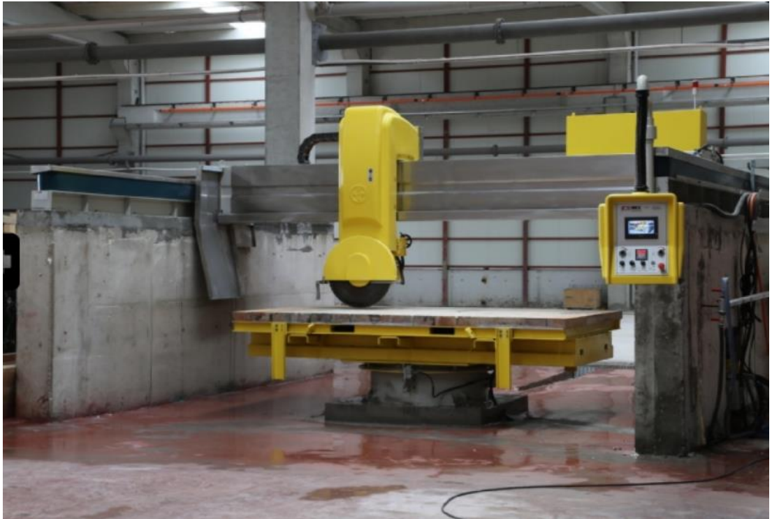
Şekil 3.1. Geleneksel köprü tipi mermer kesme makinesi (Erişim tarihi: 15.04.2018. https://www.mks.com.tr )
