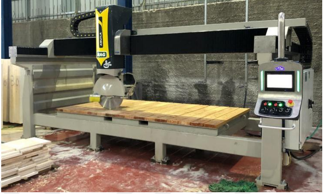
Şekil 3.46. Üretimi tamamlanmış 5 eksen köprü kesme makinesi (1. prototip)
