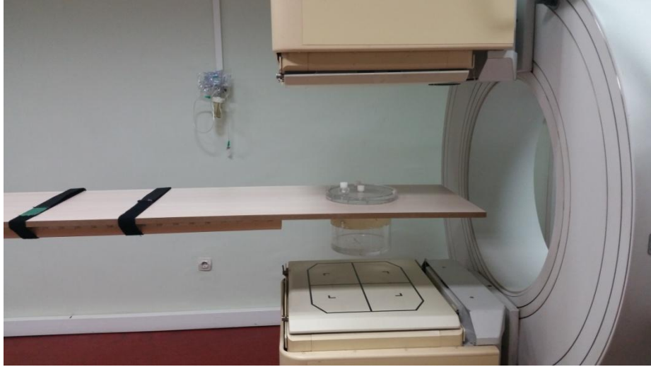
Şekil 33. Kaynak ile gama kamera arasındaki uzaklığın ayarlandığı düzenek.
