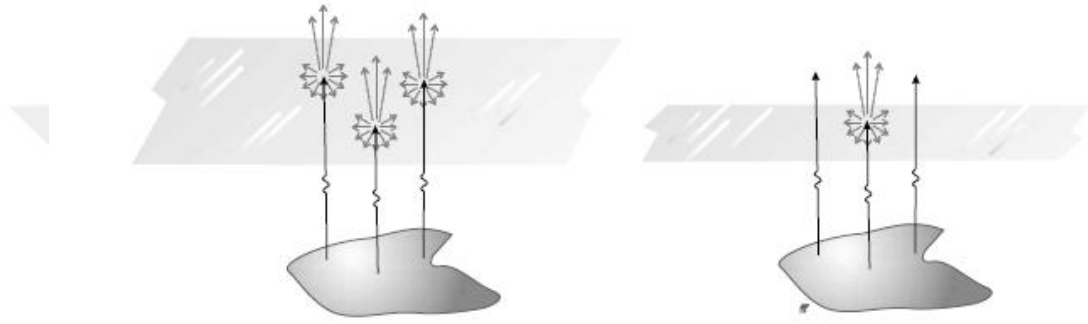
Şekil 9. Kalın ve ince kristaller. Kalın kristaller fotonların çoğunu durdurur [10].
