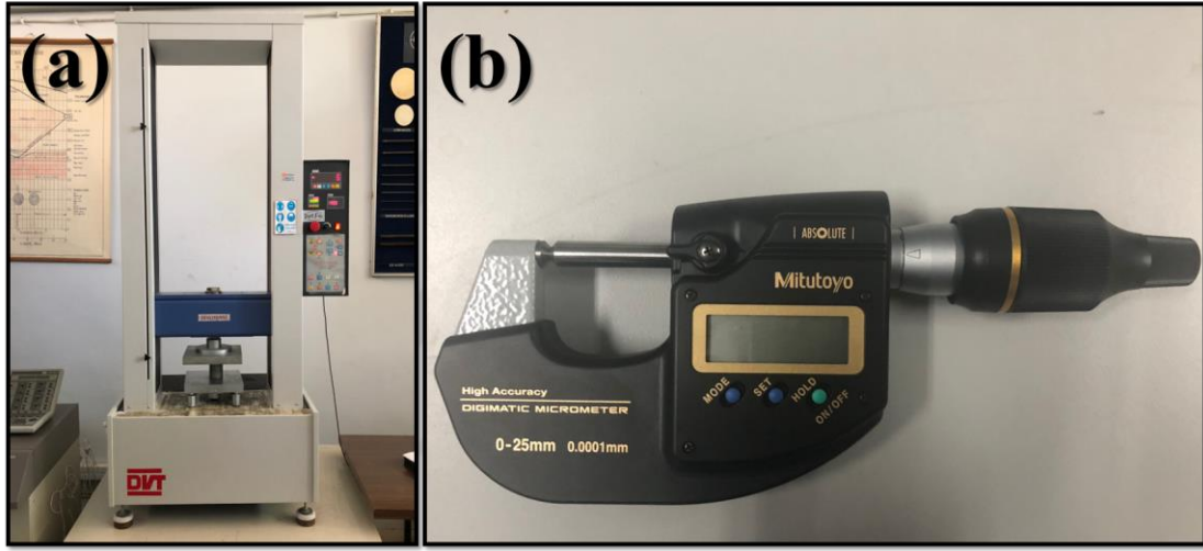
Şekil 2.6. Doku iskeletlerinin mekanik özelliklerinin belirlenmesi amacıyla kullanılan (a) basma testi makinesi ve (b) kalınlık ölçmek için kullanılan dijital mikrometre.
