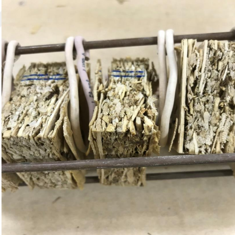
Fotoğraf 4.7 - Kaynatma testi sonrası dađılan OSB2 numuneleri ( foto: Ferhat ÇAKMAK )
