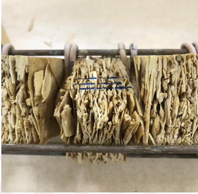
Fotoğraf 4.6 - Kaynatma testi sonrası tamamen dađılan OSB3 numuneleri ( foto: Ferhat ÇAKMAK )
