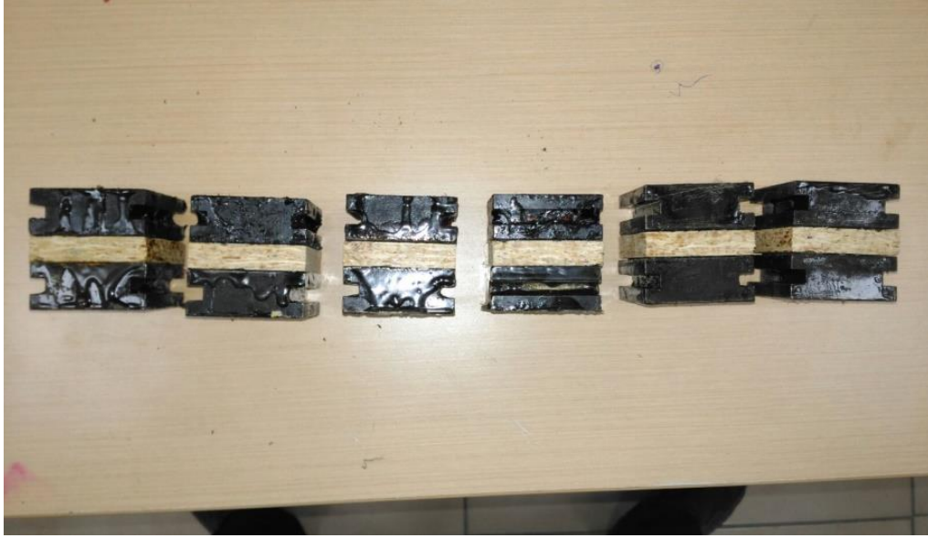
Fotoğraf 3.5 - İç yapışma testi için numunelerin hazırlanması ( foto: Ferhat ÇAKMAK )
