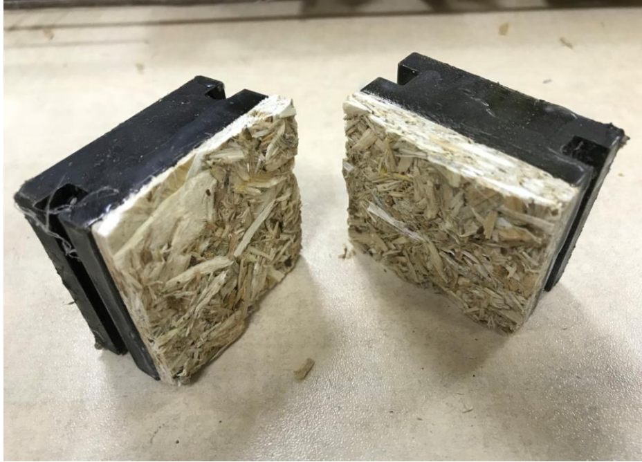
Fotoğraf 4.3 - İç yapışma testi sonrası OSB numunesi ( foto: Ferhat ÇAKMAK )
