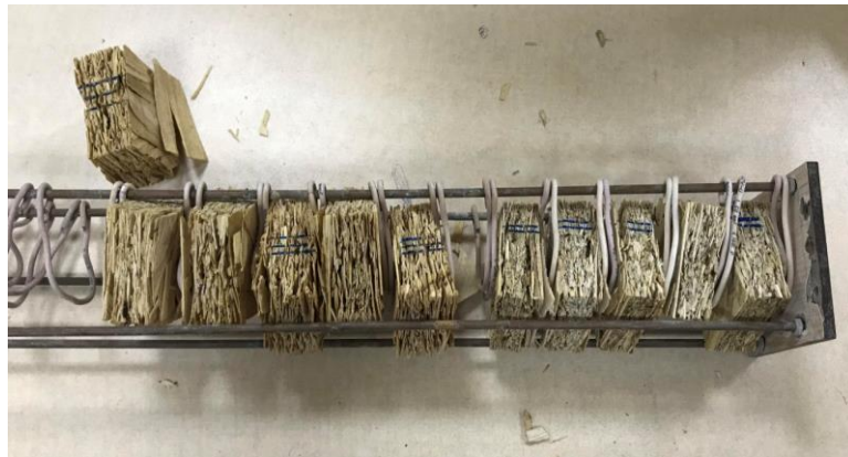
Fotoğraf 4.5 - Kaynatma testi sonrası OSB3 numunelerinin tamamen dağıldığı gözlemlenmiştir. ( OSB2 numuneleri OSB3'e göre biraz daha az dağılsa da numuneler sonraki aşamada çekme testi uygulanamayacak kadar dağılmışlardır.) ( foto: Ferhat ÇAKMAK )
