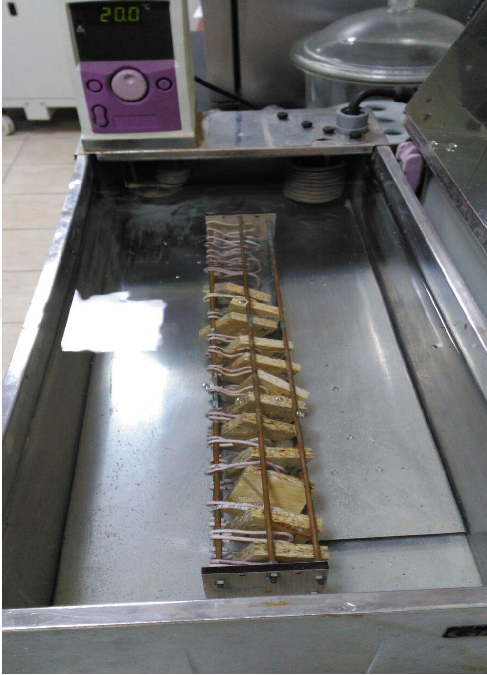
Fotoğraf 3.7 - Daldırma deneyinin su banyosunda yapılışı ( foto: Ferhat ÇAKMAK )
