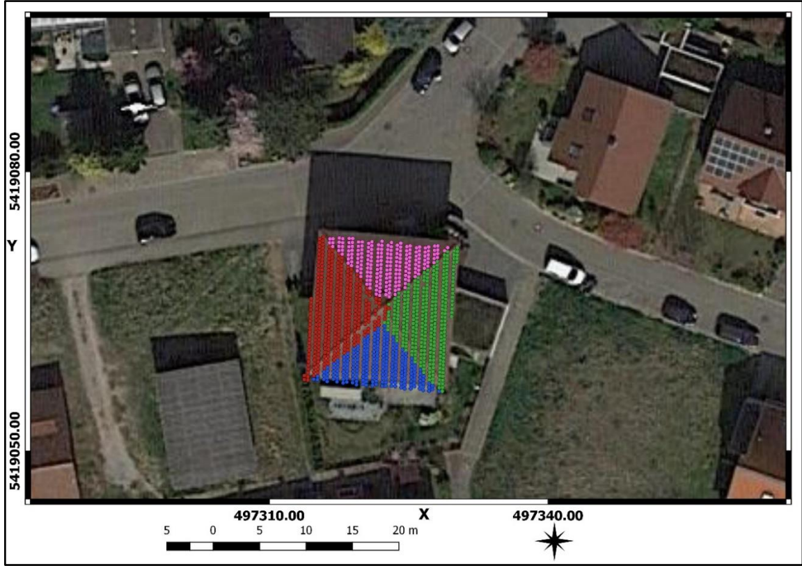
Şekil 60. Veri #5 için I-RANSAC algoritması ile çıkarılan bina çatı düzlemlerinin Google uydu haritaları üzerinde gösterimi
