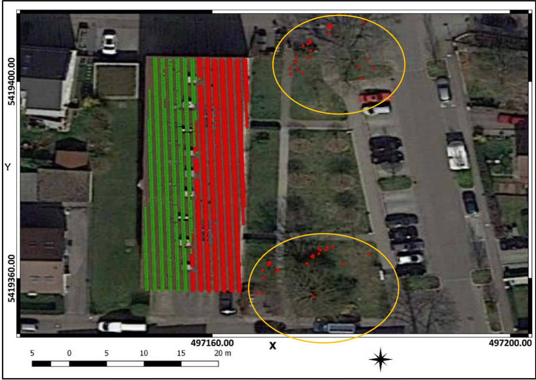
Şekil 74. Veri #8 için RANSAC algoritması ile çıkarılan bina çatı düzlemlerinin Google uydu haritaları üzerinde gösterimi
