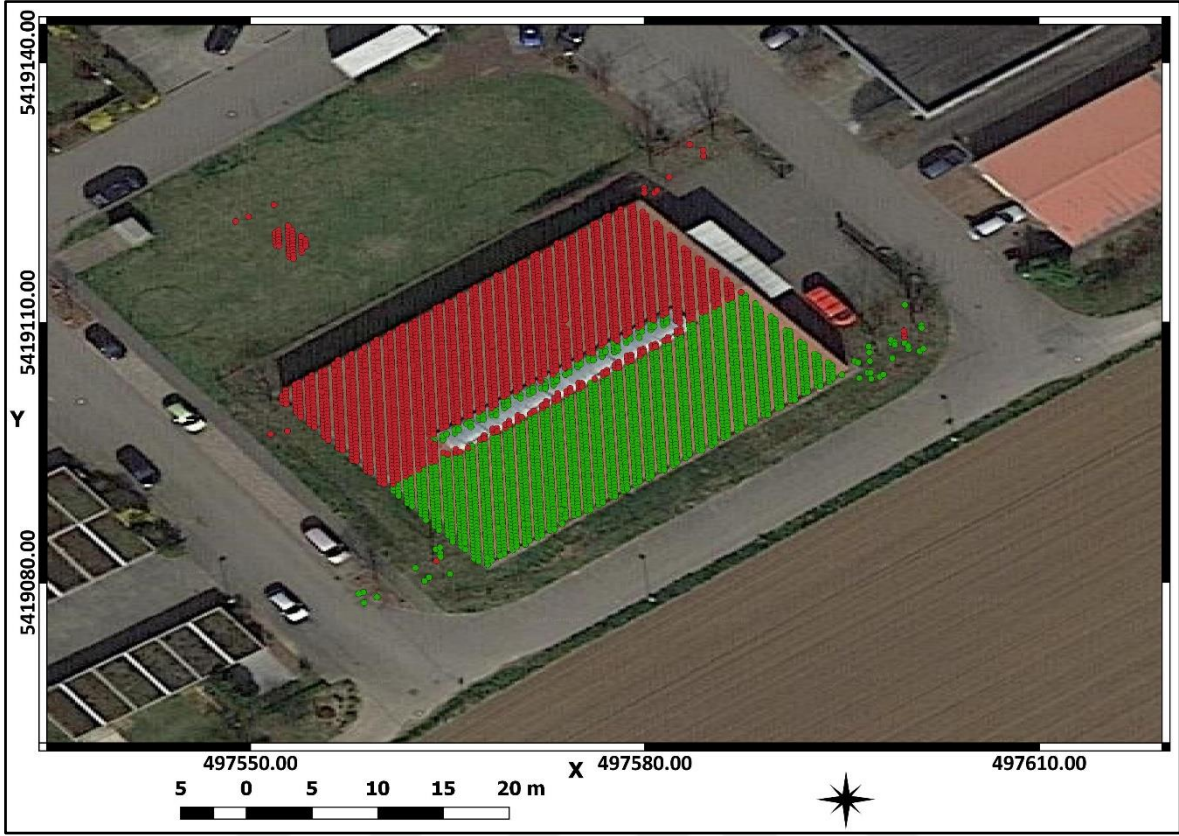
Şekil 64. Veri #6 için RANSAC algoritması ile çıkarılan bina çatı düzlemlerinin Google uydu haritaları üzerinde gösterimi
