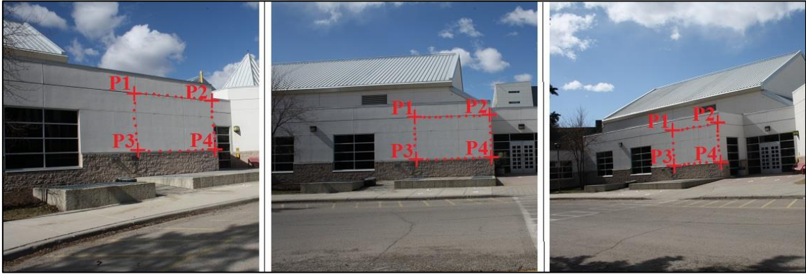
Şekil 6. Yer fotogrametrisinde farklı açı ve yerlerden çekilmiş yüksek bindirmeli fotoğraflar
