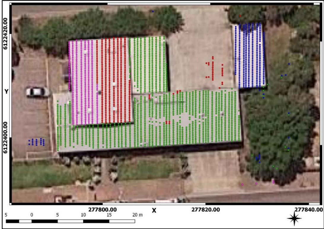
Şekil 54. Veri #4 için RANSAC algoritması ile çıkarılan bina çatı düzlemlerinin Google uydu haritaları üzerinde gösterimi
