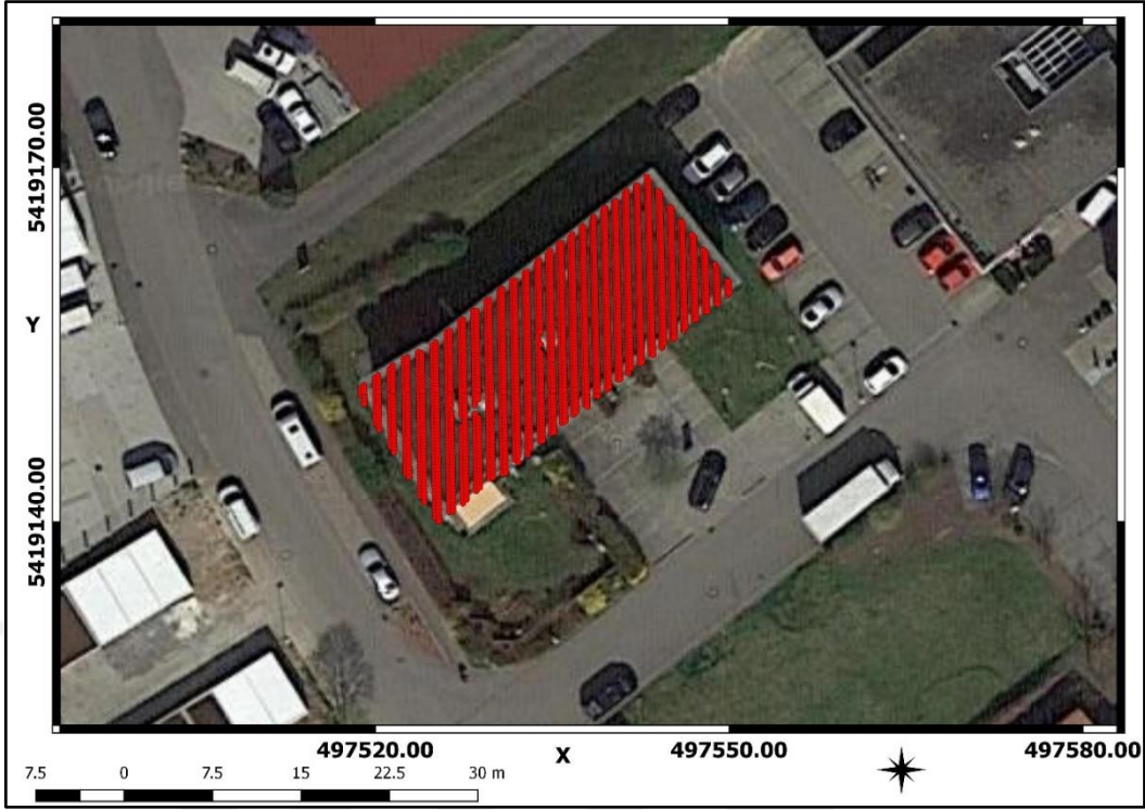
Şekil 70. Veri #7 için I-RANSAC algoritması ile çıkarılan bina çatı düzlemlerinin Google uydu haritaları üzerinde gösterimi
