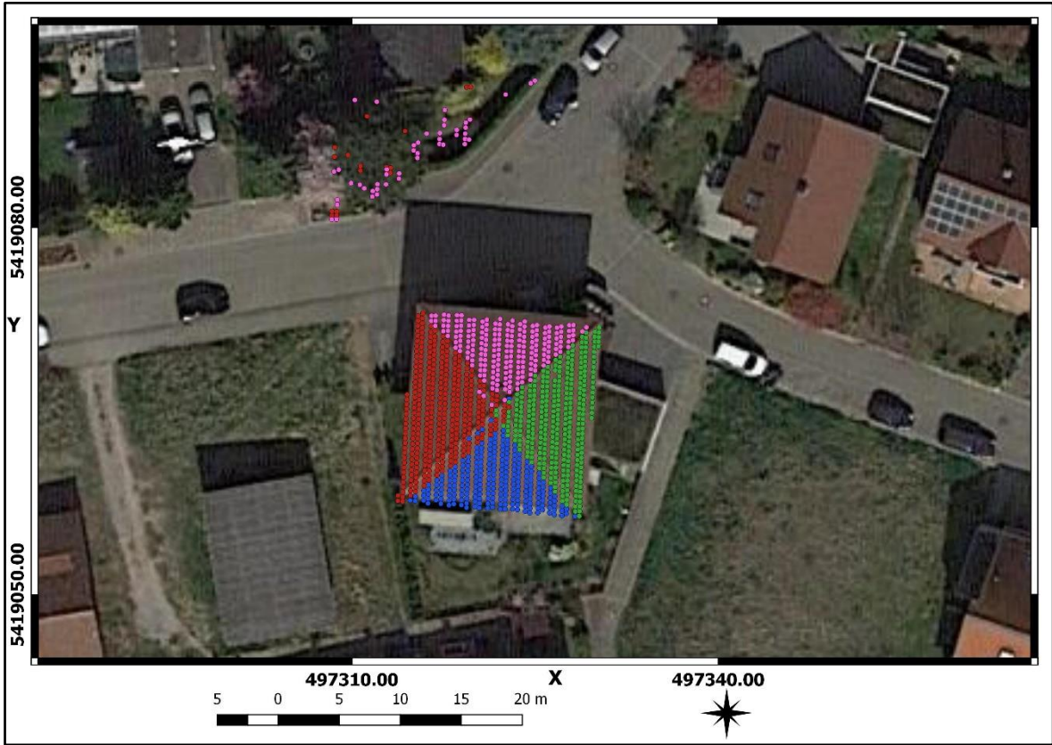
Şekil 59. Veri #5 için RANSAC algoritması ile çıkarılan bina çatı düzlemlerinin Google uydu haritaları üzerinde gösterimi
