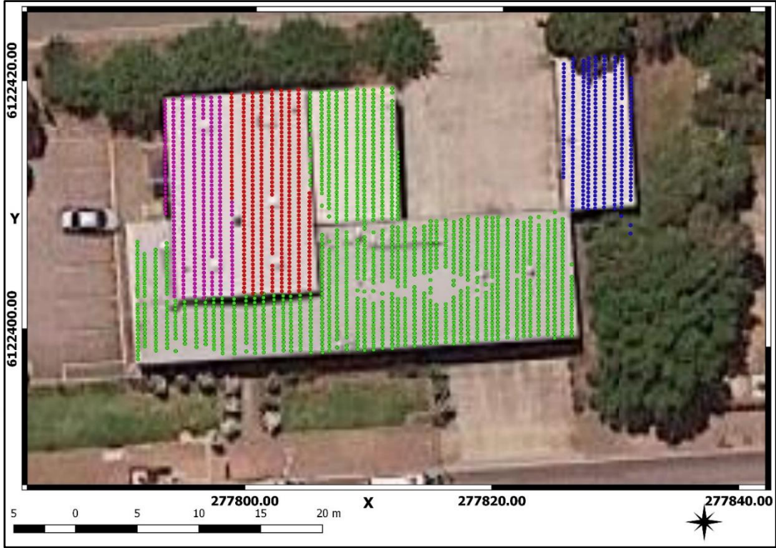
Şekil 55. Veri #4 için I-RANSAC algoritması ile çıkarılan bina çatı düzlemlerinin Google uydu haritaları üzerinde gösterimi
