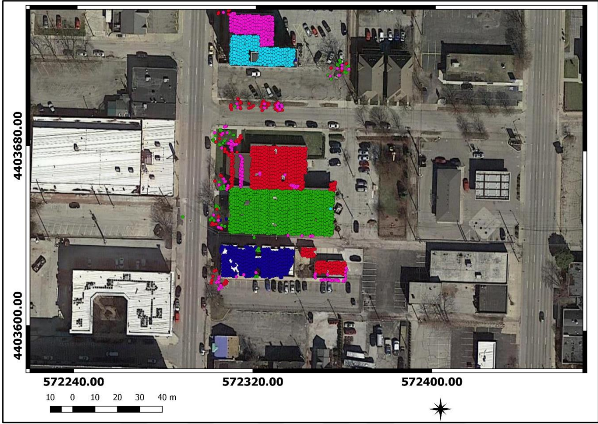
Şekil 79. Alan #1 için RANSAC algoritması ile çıkarılan bina çatı düzlemlerinin Google uydu haritaları üzerinde gösterimi
