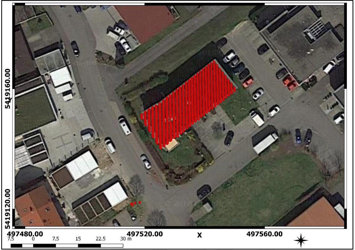
Şekil 69. Veri #7 için RANSAC algoritması ile çıkarılan bina çatı düzlemlerinin Google uydu haritaları üzerinde gösterimi
