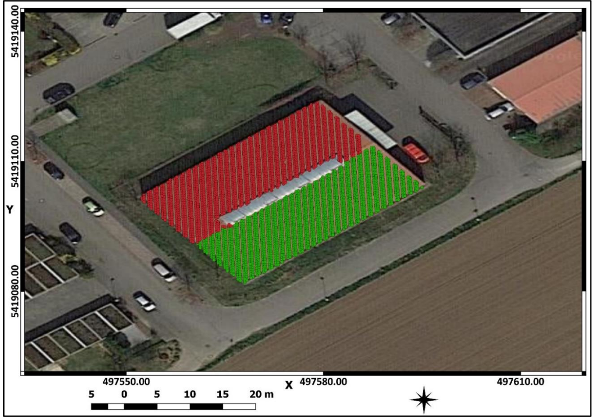
Şekil 65. Veri #6 için I-RANSAC algoritması ile çıkarılan bina çatı düzlemlerinin Google uydu haritaları üzerinde gösterimi
