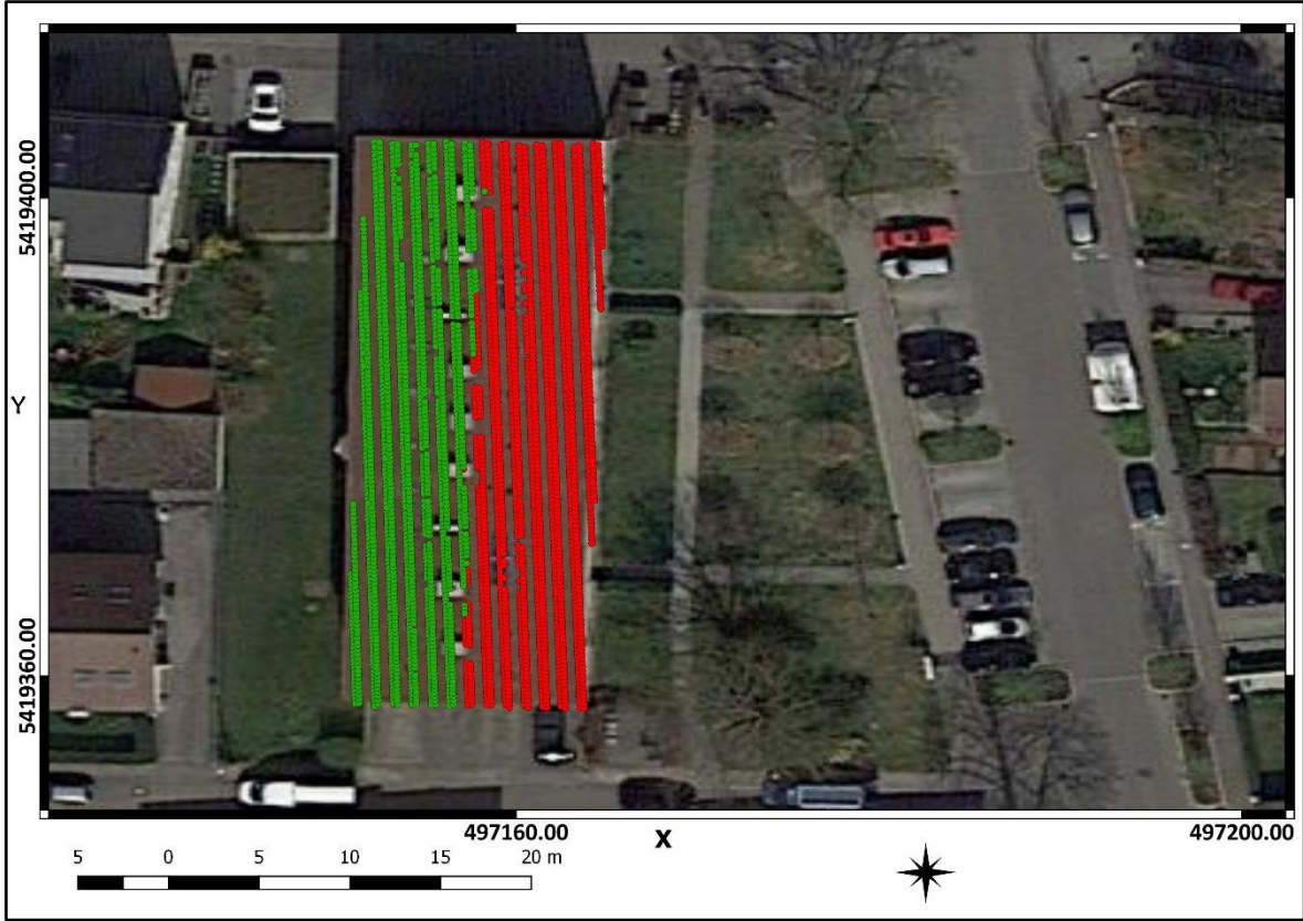
Şekil 75. Veri #8 için I-RANSAC algoritması ile çıkarılan bina çatı düzlemlerinin Google uydu haritaları üzerinde gösterimi
