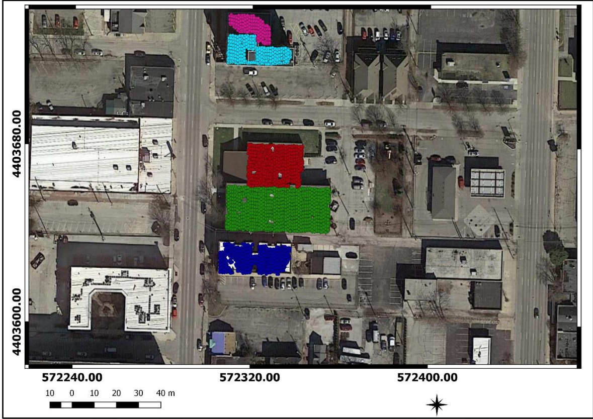
Şekil 80. Alan #1 için I-RANSAC algoritması ile çıkarılan bina çatı düzlemlerinin Google uydu haritaları üzerinde gösterimi
