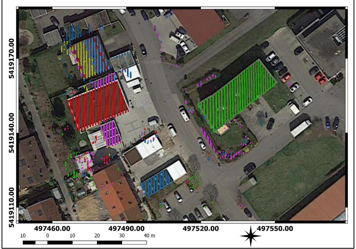
Şekil 89. Alan #3 için RANSAC algoritması ile çıkarılan bina çatı düzlemlerinin Google uydu haritaları üzerinde gösterimi
