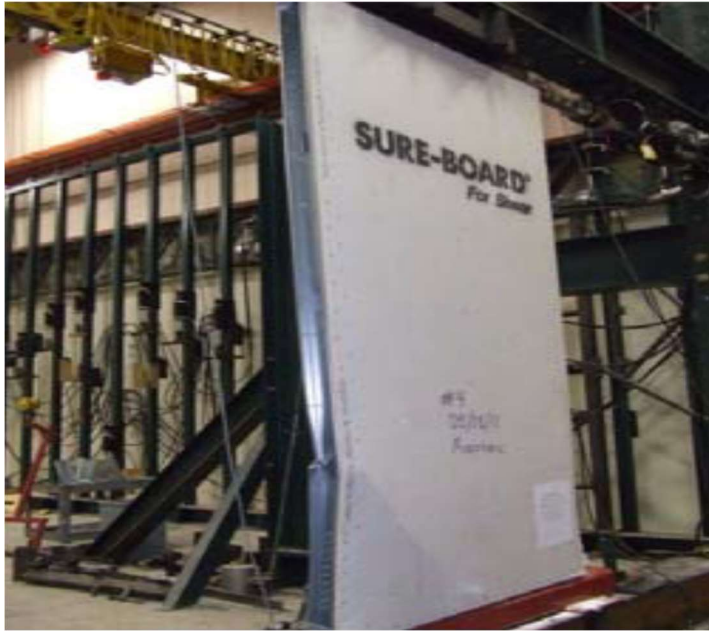
Resim 2.4. Son metal dikme elemanın burkulması [21]
