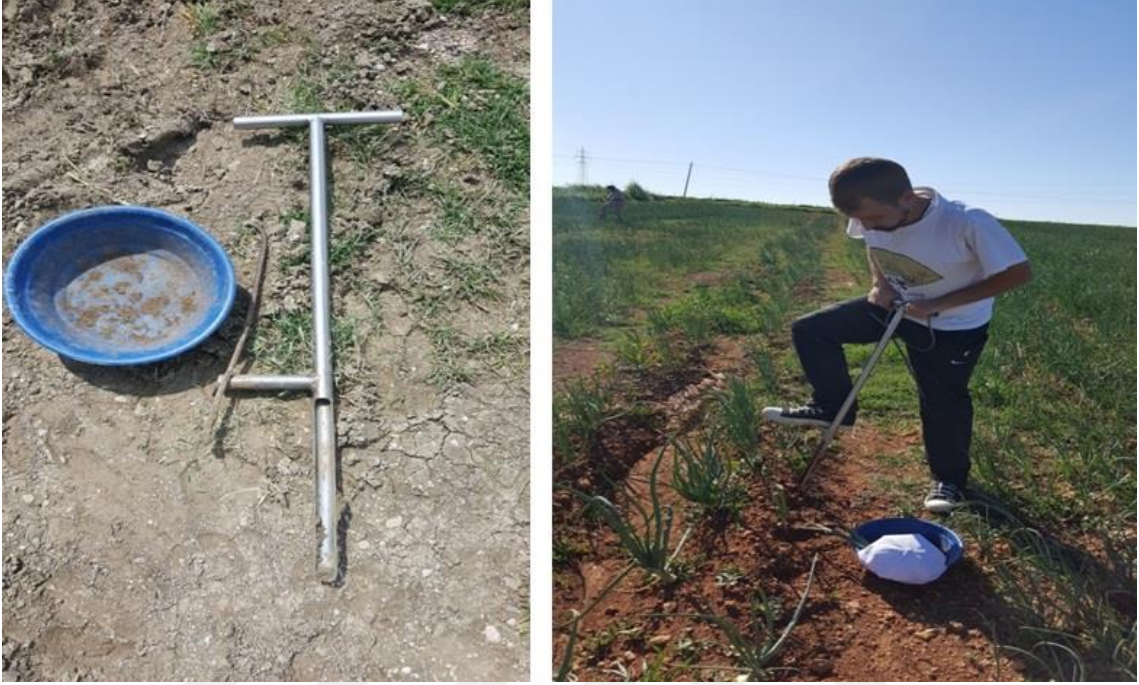
Şekil 3.4. Örnek toplanırken kullanılan malzemeler ve toprak örneğinin alınma şekli
