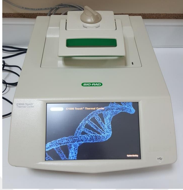
Şekil 3.12. Tez çalışmasında kullanılan ısı döngüsü cihazı
