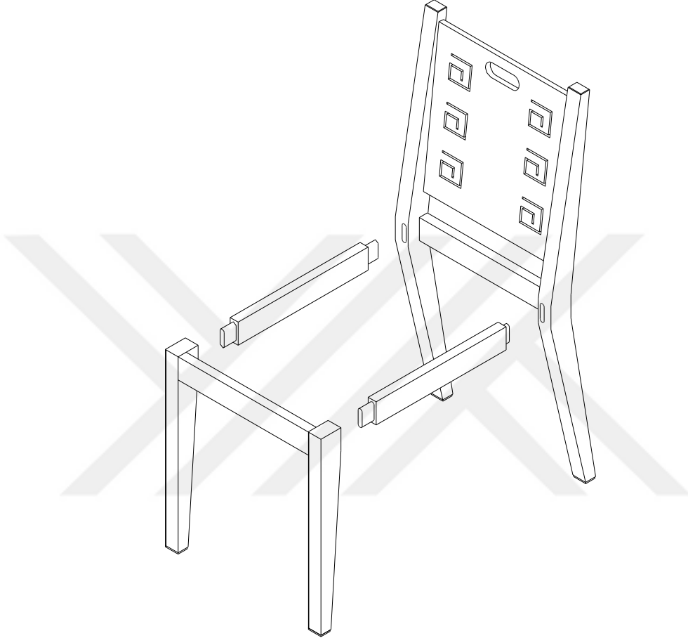
Şekil 3.10: Demonte sandalye elemanlarında asli bağlantı tekniği.
