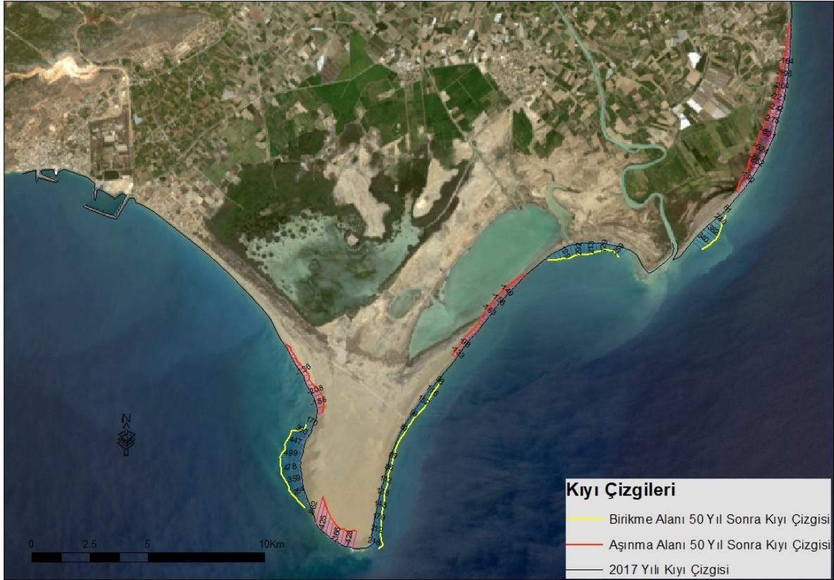
Şekil 37: Göksu deltası aşınma ve birikme sonucunda 50 yıl sonra kıyı çizgisi değişimi
