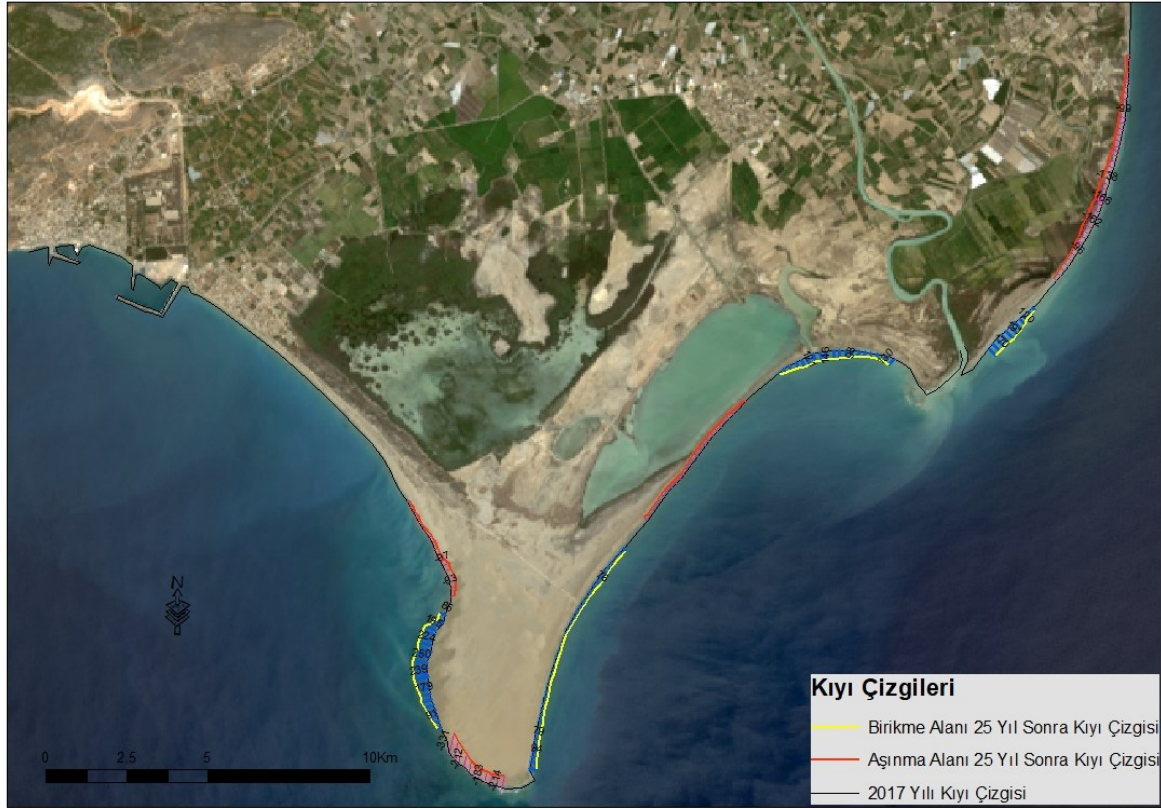
Şekil 34: Göksu deltası 25 yıl sonra aşınma ve birikme sonucu kıyı çizgisi değişimi
