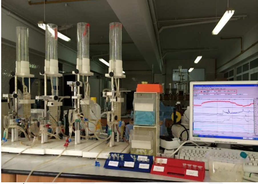
Şekil 2.4. In vitro çalışmaların yapıldığı izole organ banyosu sistemi
