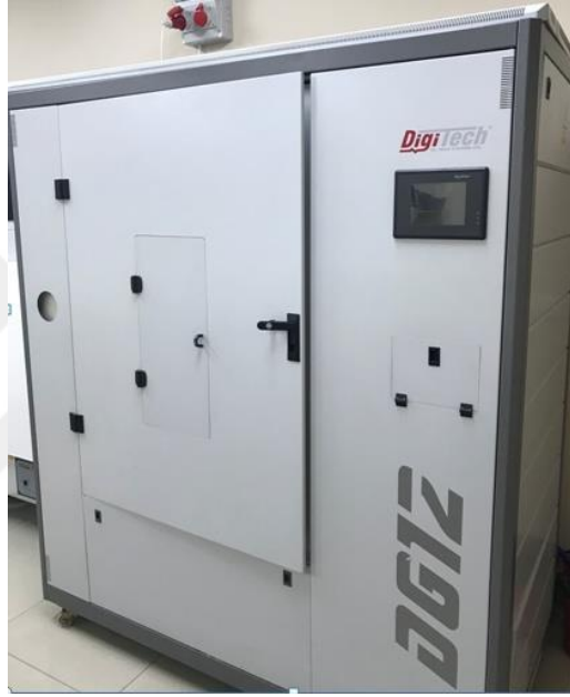
Şekil 3.7. Laboratuvar tipi 3 raflı iklim dolabı genel görünüşü
