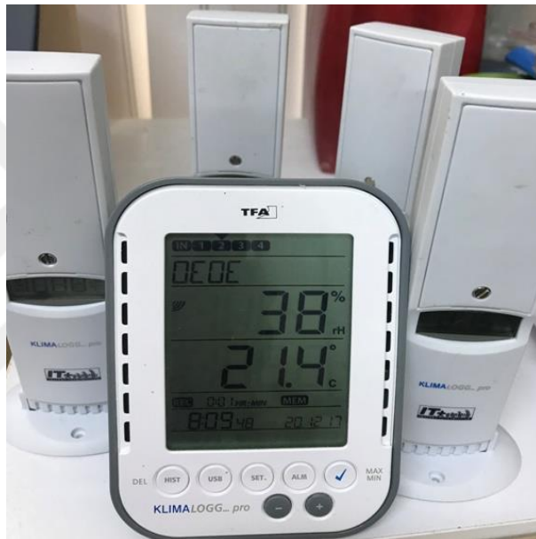
Şekil 3.8. Dört harici kablosuz sensörlü bağıl nem ve sıcaklık ölçer
