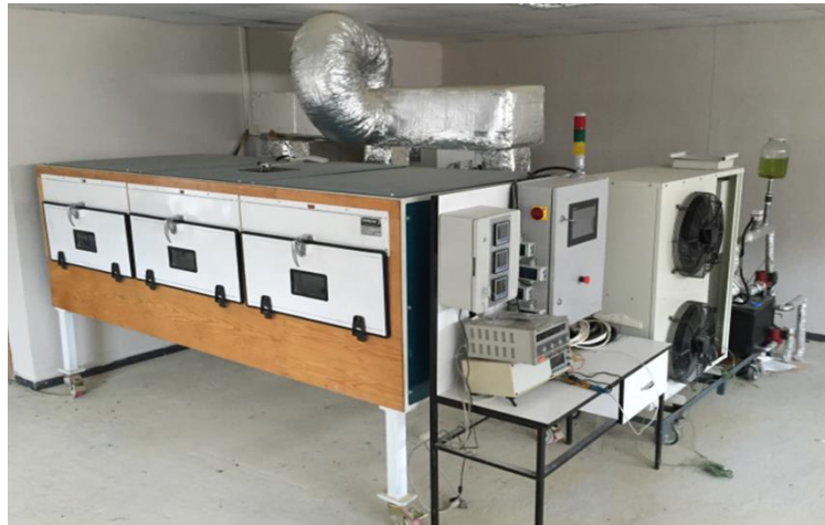
Şekil 3.5. 3 Rafı yoğuşma üniteli kurutma sistemi
