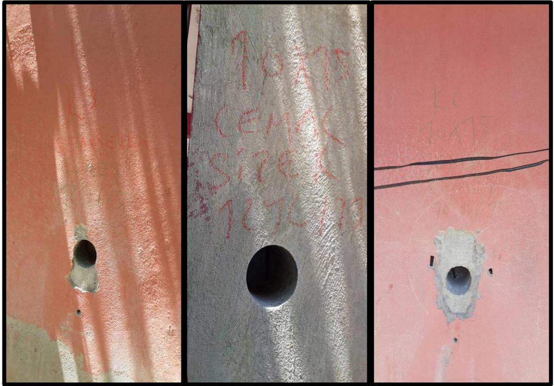
Şekil 3.5. A Yapısından Kolon Karot Numune Alımı
