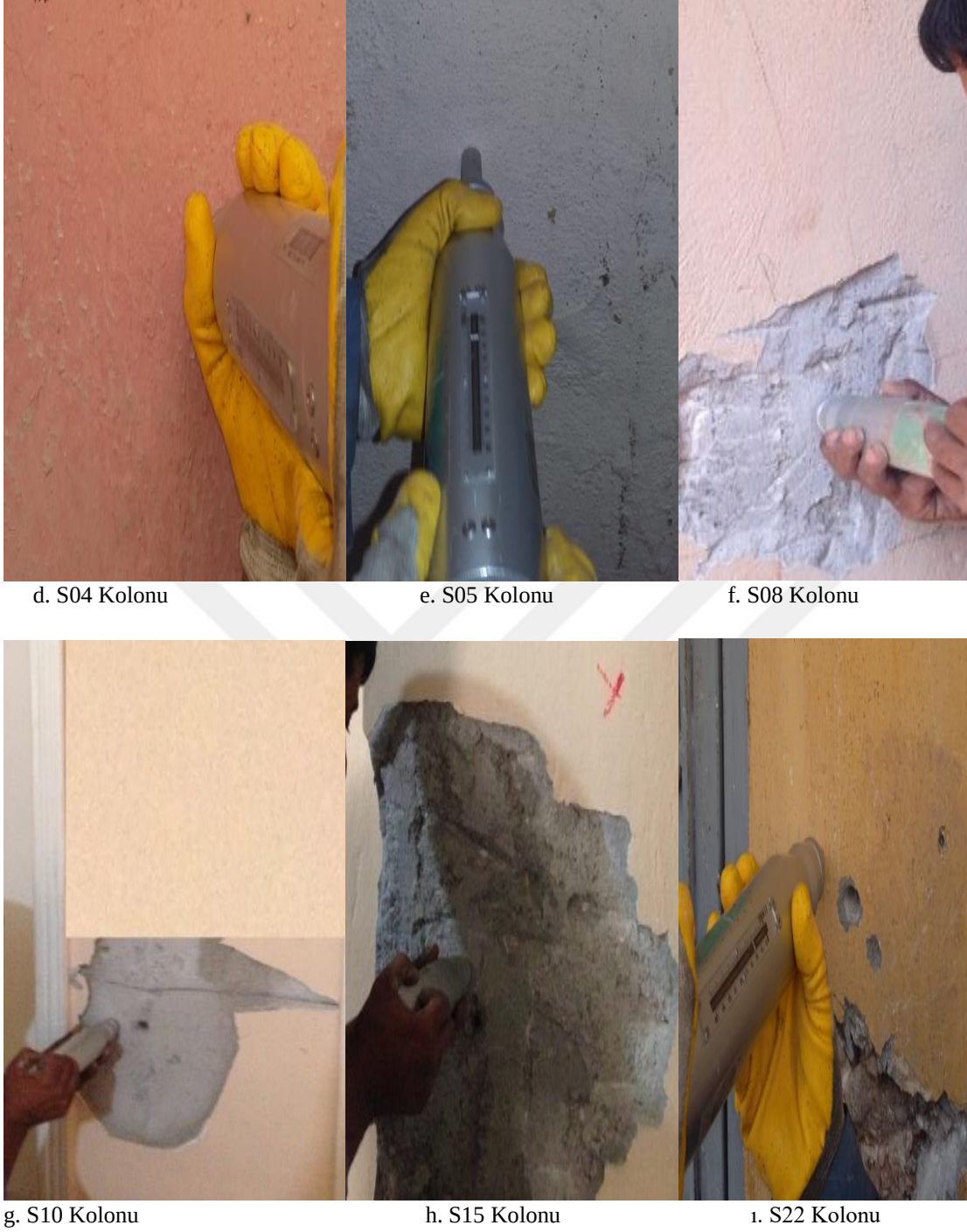
Şekil 3.16. C binasında a'dan ı'ya yapılan schimit testi görüntüleri
