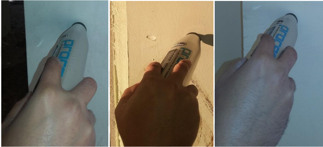
Şekil 3.23. Kolon Schmidt Testi görüntüleri
