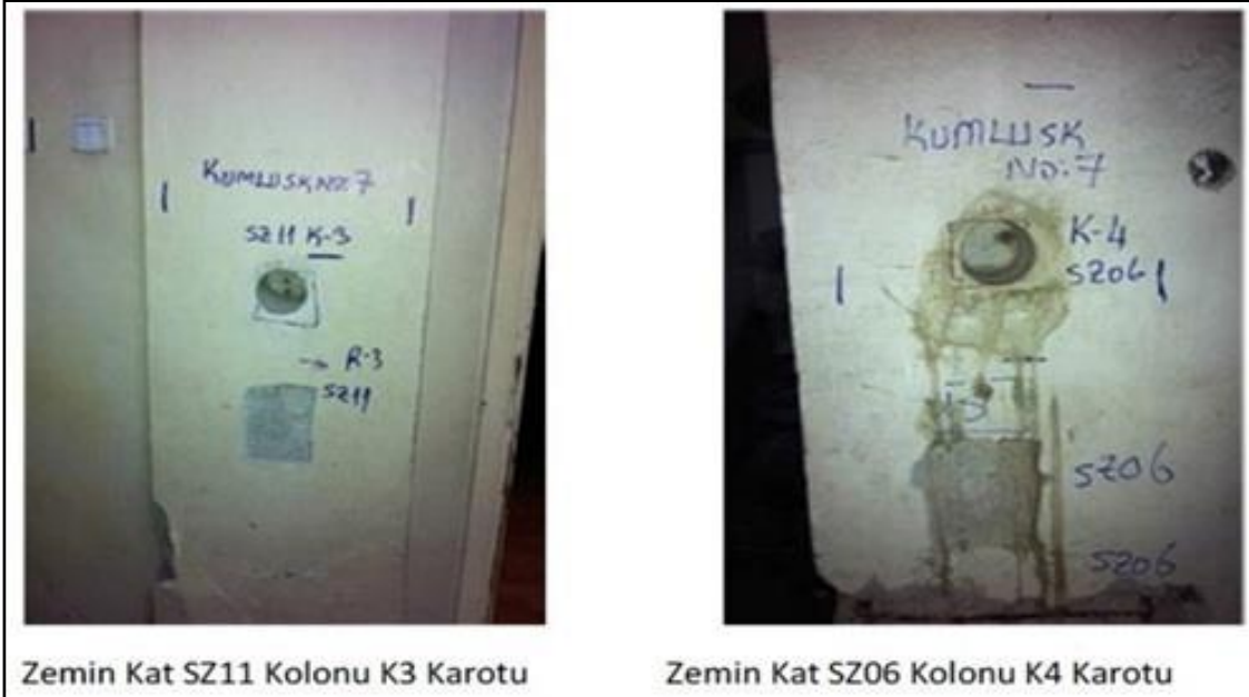
Şekil 2.15. Betonarme kolon yüzlerinden karot numune alınması
