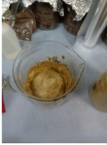
Şekil 3.5: Yanma reaksiyonu sonrası oluşmuş süngerimsi yapıdaki toz karışım.
