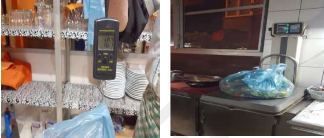
Şekil 3.4 Atıkların tartım işleminde kullanılan dijital el tartısı ve sanayi tipi tartı.
