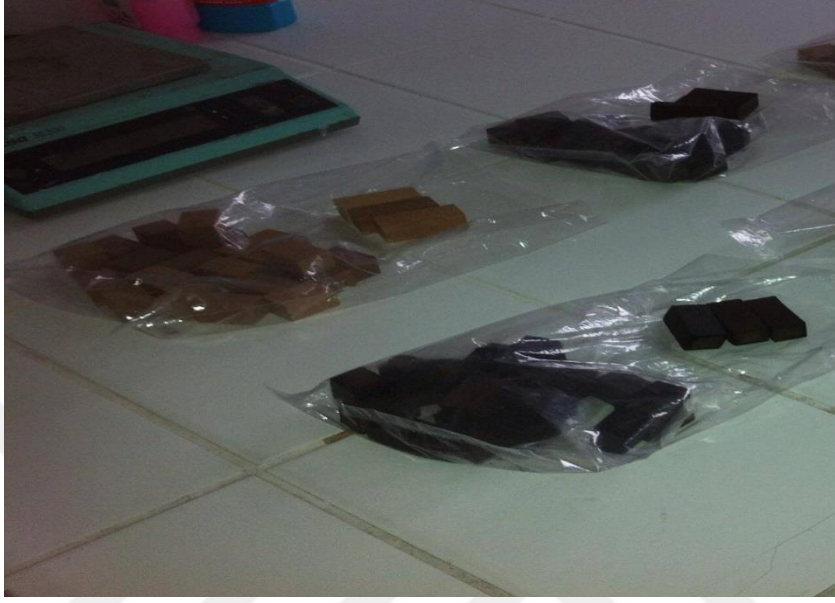
Şekil 2.2: Isıl işlem görmüş deney örnekleri.
