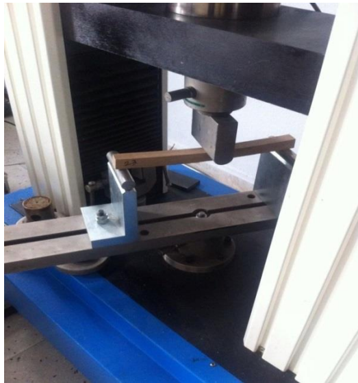
Şekil 2.3: Örneklerin eğilme direnci ölçümü.
