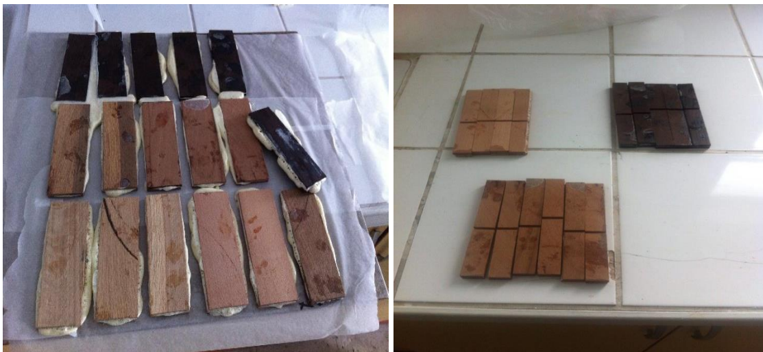
Şekil 2.4. Örneklerin yapışma direnci ölçümüne hazırlığı.
