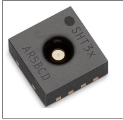
Şekil 5.3 SHT31 sıcaklık ve nem sensörü görünümü
