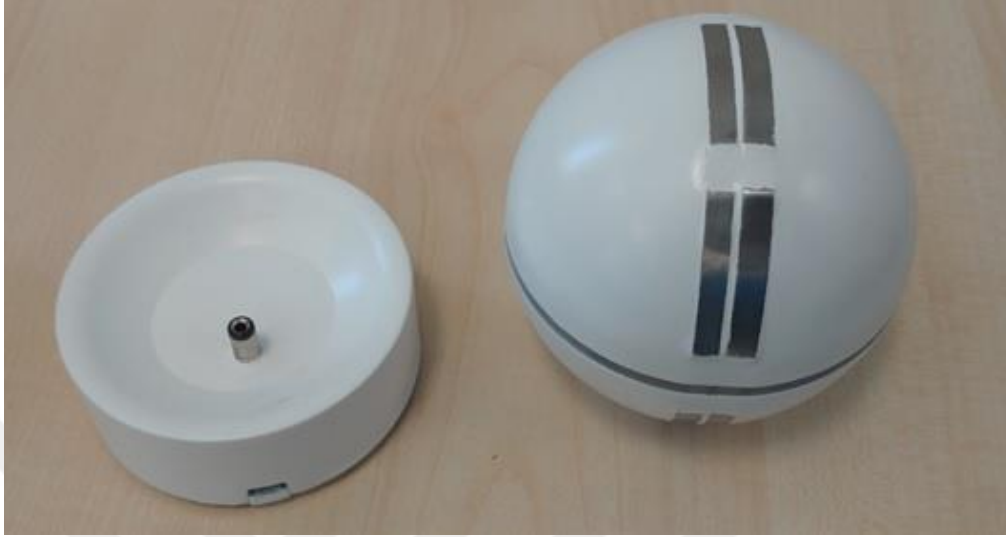
Şekil 4.4 Tasarımı yapılan sensör grubu ve şarj istasyonun prototipi
