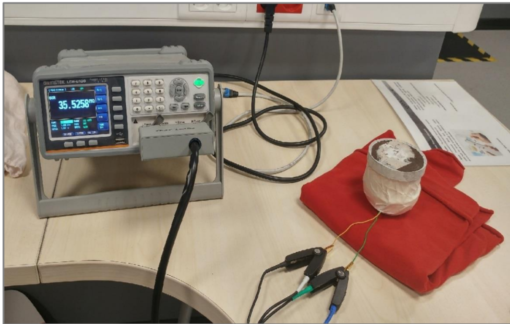
Şekil 3.1 Tekstil ürünlerinin dirençlerinin ölçülmesi için hazırlanan deney düzeneği
