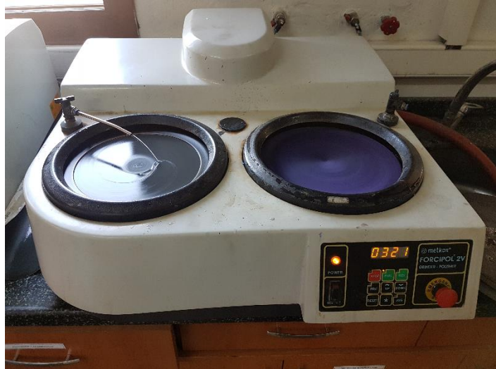
Şekil 4.7. Deneyde kullanılan METKON marka zımparalama ve parlatma cihazı
