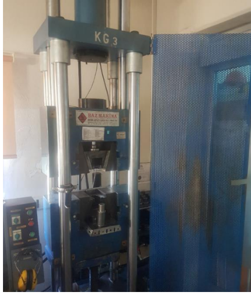
Şekil 4.19. Deneyde kullanılan BAZ marka makine çekme cihazı (60 Tonluk)
