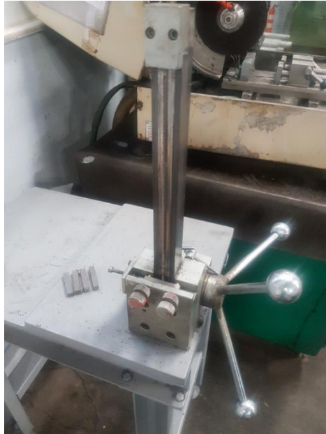
Şekil 4.22. Deneyde kullanılan çentik açma makinası
