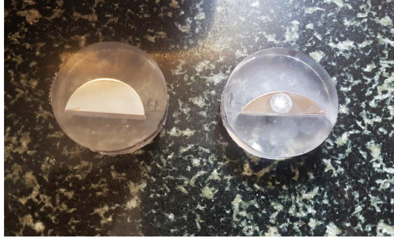
Şekil 4.6. Bakalite alınmış numuneler
