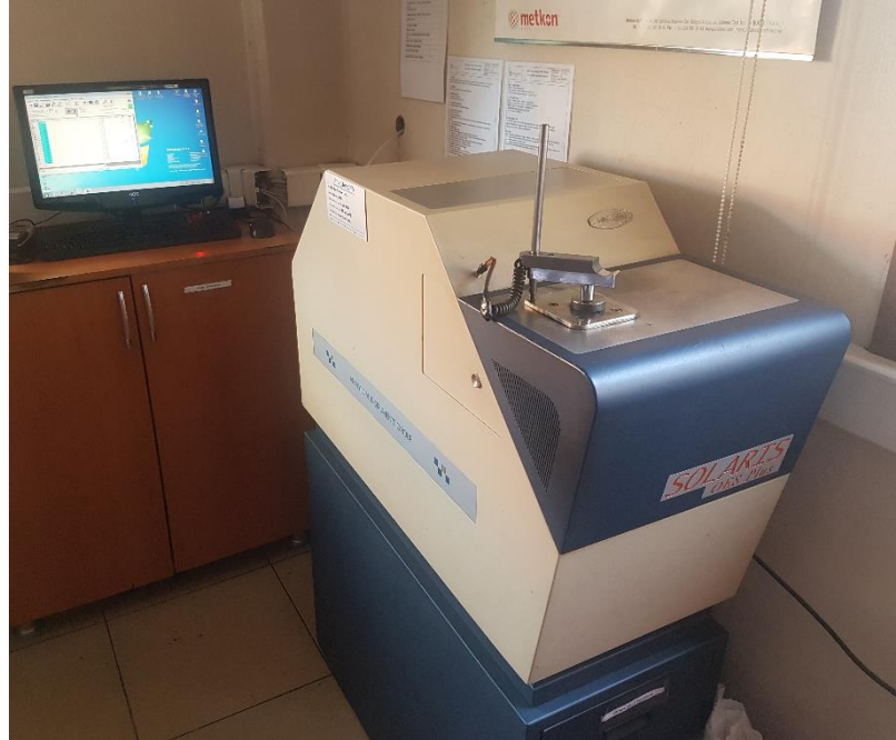
Şekil 4.3. Deneyde kullanılan SOLARIS marka spektrometre cihazı
