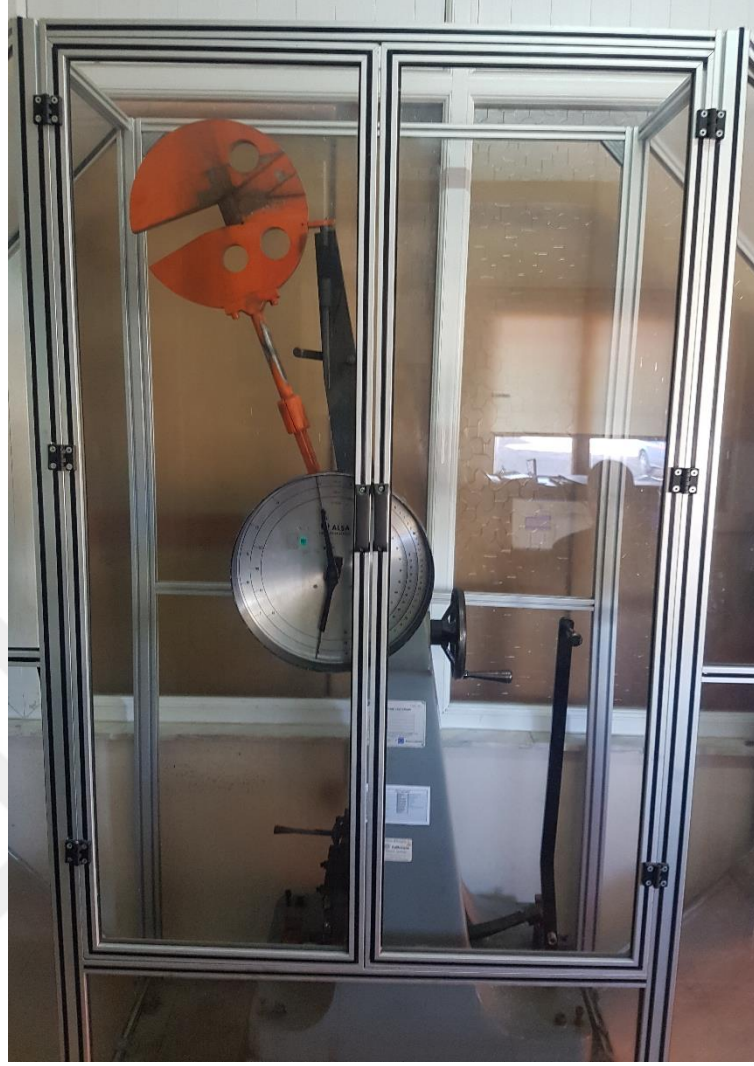
Şekil 4.25. Deneyde kullanılan ALŞA marka çentik darbe test cihazı
