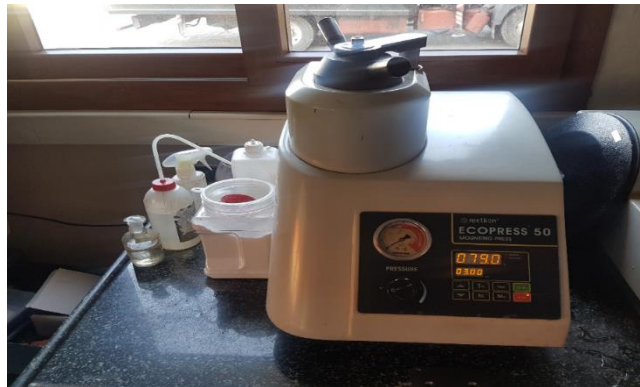
Şekil 4.5. Deneyde kullanılan ECOPRESS marka bakalit cihazı
