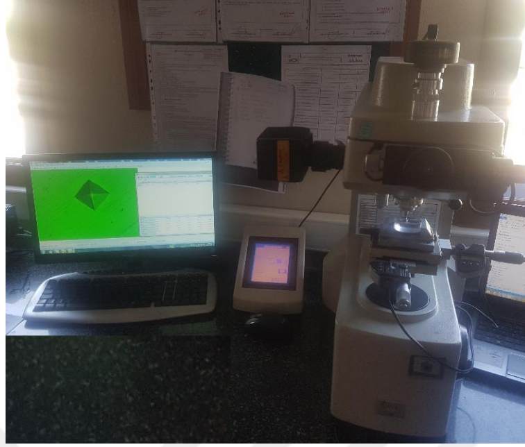
Şekil 4.9. Deneyde kullanılan MITUTOYO marka mikro sertlik ölçüm cihazı
