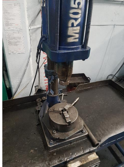
Şekil 4.2. Deneyde kullanılan Marka markalama presi
