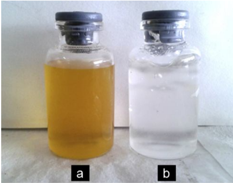
Şekil 2.11. (a) 120 dk boyunca 100 \square 'de hazırlanan 50 ppm SNP içeren SNP-CMC, (b) kontrol jeli (Das ve ark., 2015)
