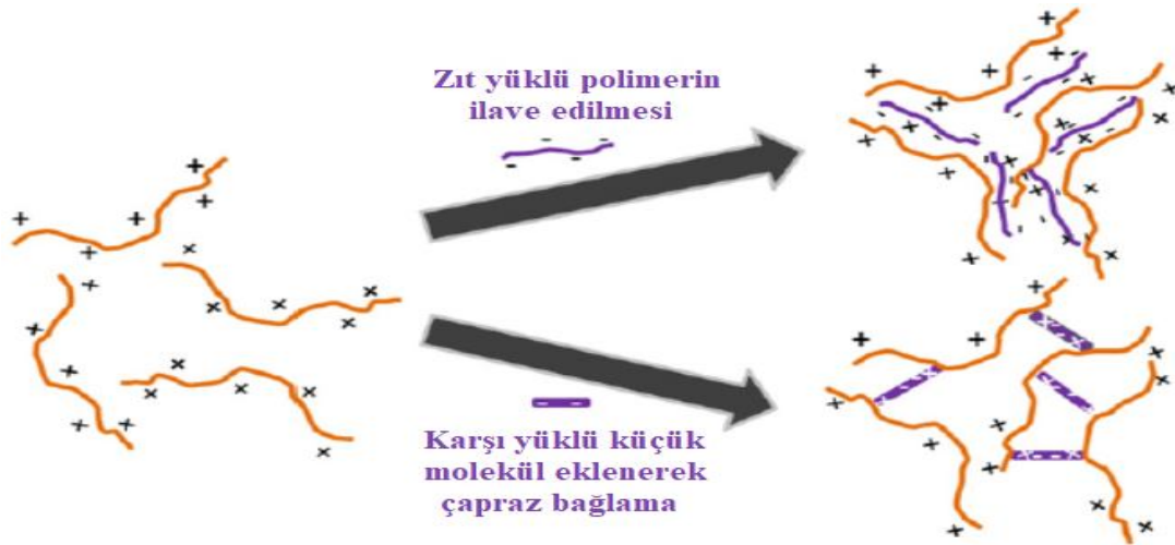
Şekil 2.17. Ters yüklü bir polimer veya bir karşı yüklü küçük molekül eklenerek iyonik etkileşimlerine dayanan fiziksel çapraz bağlanmış hidrojel mekanizmaları (Hoare ve Kohane, 2008)
