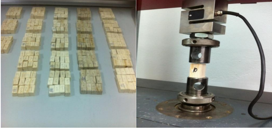
Şekil 3.15. Liflere paralel basınç direnci testi.
