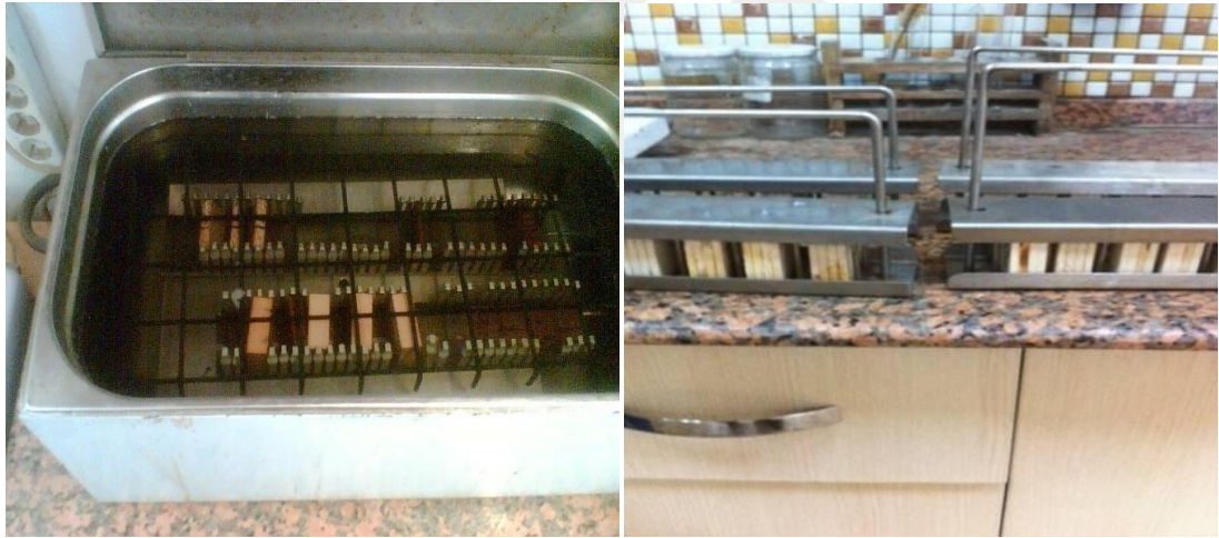
Şekil 3.7. 24 saat suda bekletme sonucu kalınlık ve ağırlık artışı testi.
