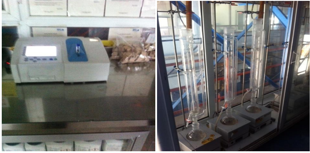
Şekil 3.8. Serbest formaldehit testi.
