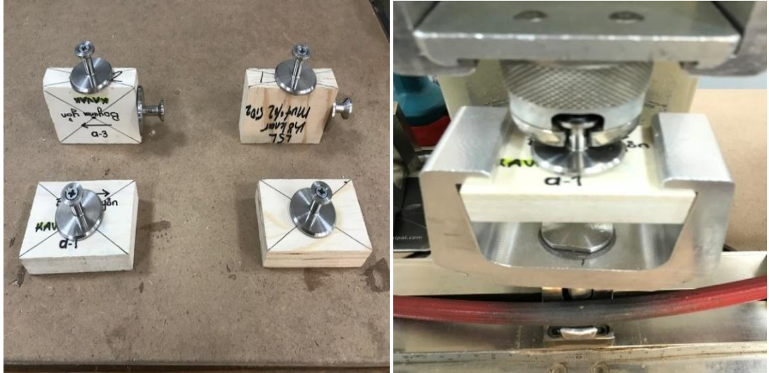
Şekil 3.12. Boyuna ve enine yönde katmanlara paralel ve dik vida tutma mukavemeti testi.
