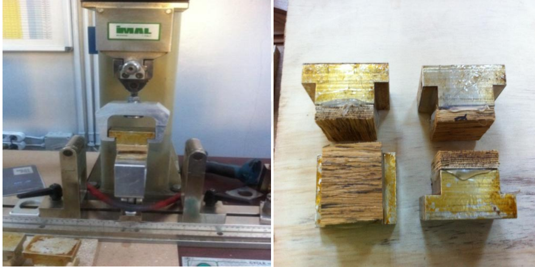
Şekil 3.9. Yüzeye dik yönde çekme direnci testi.
