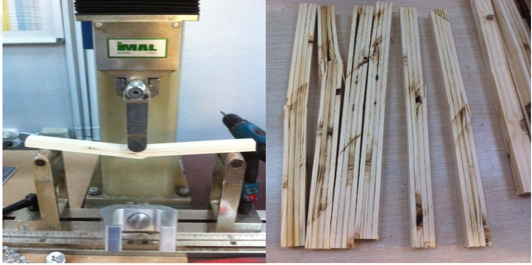
Şekil 3.10.Eğilme direnci ve eğilmede elastikiyet modülü testi.
