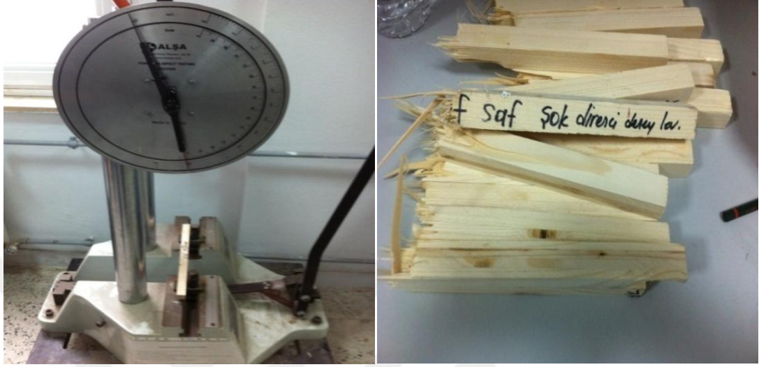
Şekil 3.16. Dinamik eğilme (şok) direnci testi.
