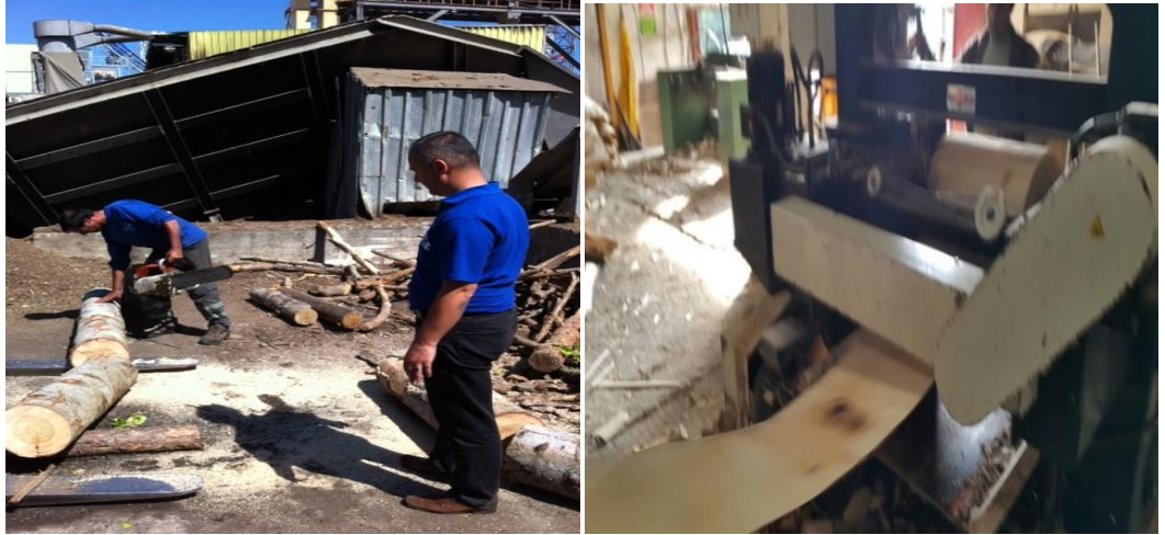
Şekil 3.1 Ağaç malzemelerdekesme ve soyma işlemi.
