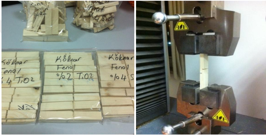
Şekil 3.14. Yapışma direnci testi.
