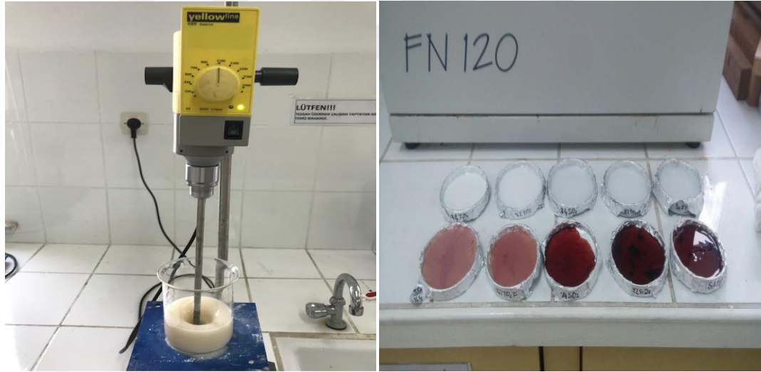
Şekil 3.17. Nano ürün takviyeli tutkal karışımları.
