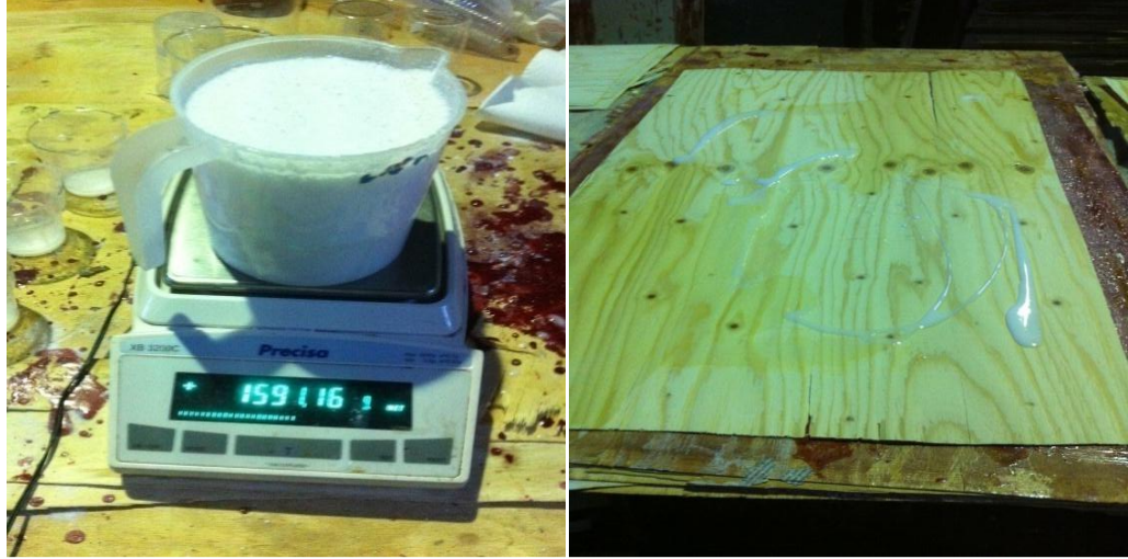
Şekil 3.5. Deney örneklerinin tutkalllanması.
