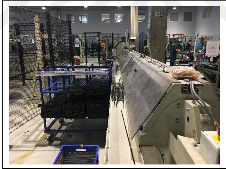
Şekil 7. 5 Şekillendirme fabrikası boru kesim prosesi
