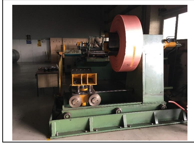
Şekil 7.2 Gelen sac ruloların dilimleme işlemi
