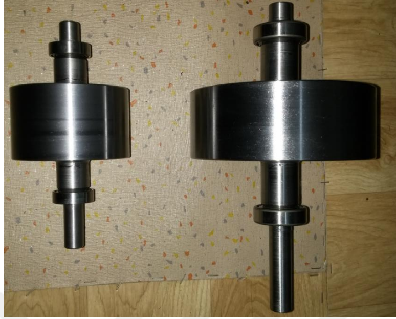
Şekil 3.23. Büyük ve küçük sisteme ait eş genişlikteki (60 mm) rotorlar
