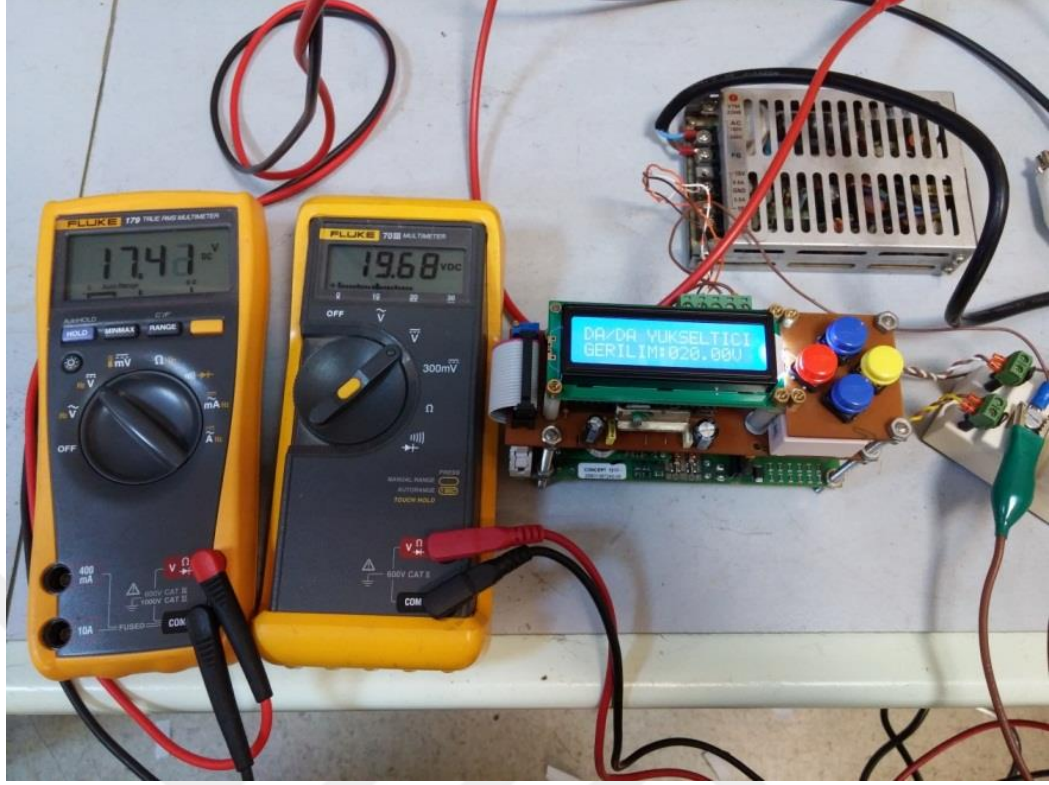
Şekil 4.9. DA/DA çeviriciye 17 V giriş gerilimi uygulanarak yapılan ölçüm sonucu
