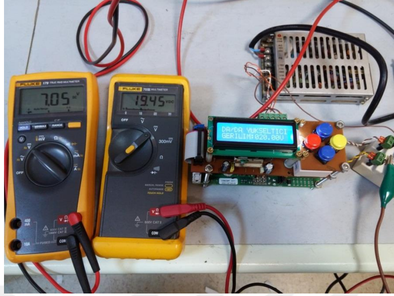
Şekil 4.11. DA/DA dönüştürücüye 7 V giriş gerilimi uygulanarak yapılan ölçüm sonucu
