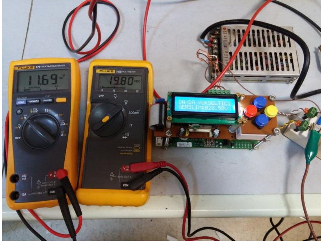
Şekil 4.10. DA/DA dönüştürücüye 12 V giriş gerilimi uygulanarak yapılan ölçüm sonucu
