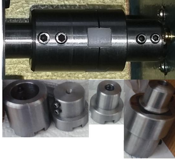
Şekil 3.21. Volan ve M/G ünitesi arasında kullanılan farklı tipte kaplin çeşitleri
