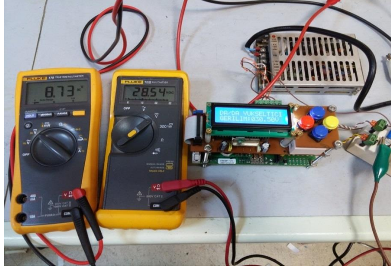
Şekil 4.13. DA/DA dönüştürücüye 9 V giriş gerilimi uygulanarak yapılan ölçüm sonucu
