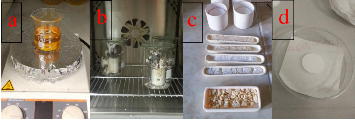
Şekil 3.1: Numune sentez adımları. a) Sol hazırlama b) Jelleşmiş numuneler kalsinasyon sonrası c) Tozlar termal işlem sonrası d) Peletlenmiş, sinterlenmiş numune
