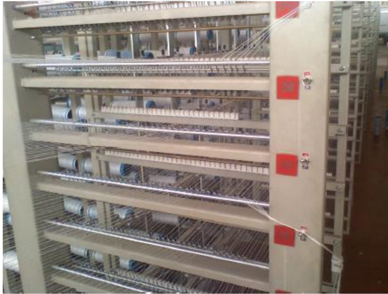
Resim 2.3. Çözgü lamel sistemi
