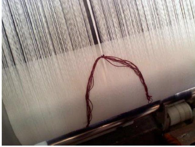
Resim 2.8. Çözümlere işaret ipliğinin bağlanması
