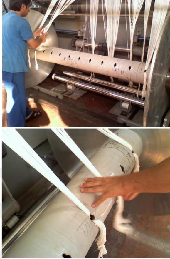
Resim 2.6. Demetlere ayrılmış çözgü uçlarının levant üzerindeki deliklere yerleştirilmesi
