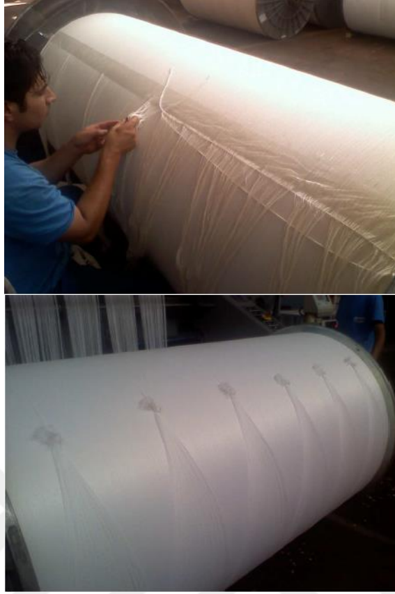
Resim 2.9. Çözümlenmiş uçlarının düğümlenmesi ve çapraz alınması
