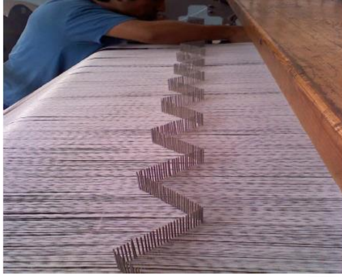
Resim 2.7. Çözügünün ön taraktan geçişi
