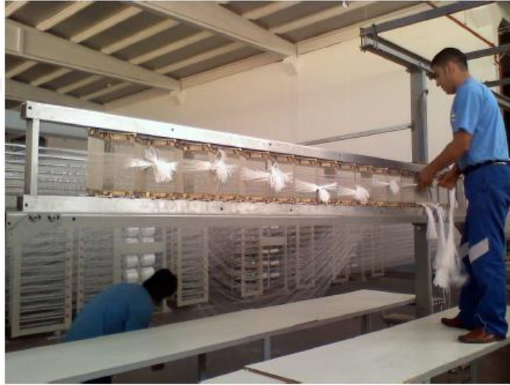
Resim 2.4. Çözgülerin arka taraktan geçirilişi
