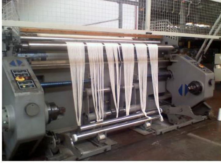
Resim 2.5. Çözüğü uçlarının levant sarımına hazırlanması
