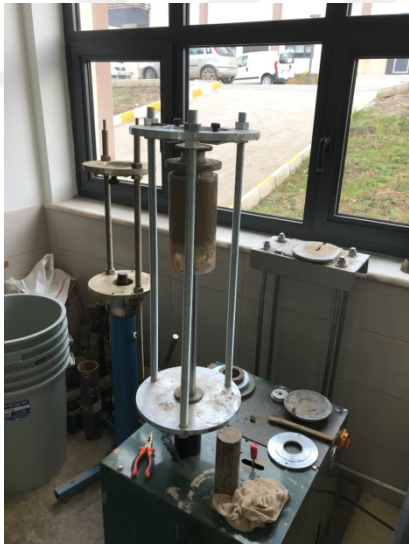
Şekil 4.15. Numunenin konsolidasyon hücresinden kesme kutusu halkasının içine alınması
