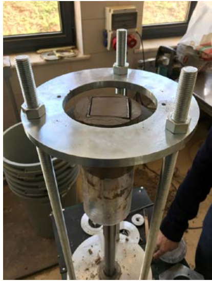
Şekil 4.15. Numunenin konsolidasyon hücresinden kesme kutusu halkasının içine alınması
