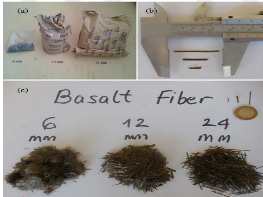
Şekil 4.4. Bazalt fiberler (a) torbalanmış bazalt fiberler, (b ve c) değişik uzunluklardaki bazalt fiberler (Ndepote ve Sert, 2017)
