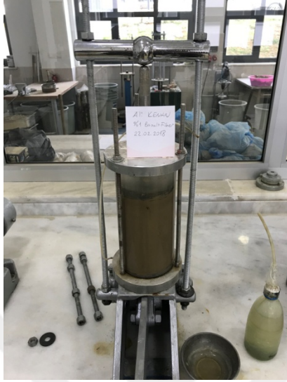
Şekil 4.14. Hücresine koyulan numunelerin 75 kPa düşey gerilme altında yeniden oluşturulması
