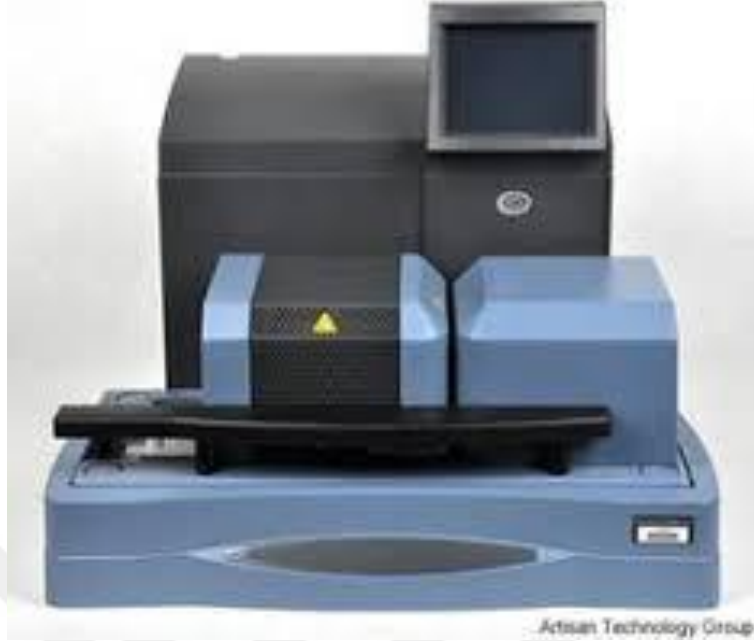
Şekil 5.11. TA Instruments marka STDQ600 model termal analiz cihazı
