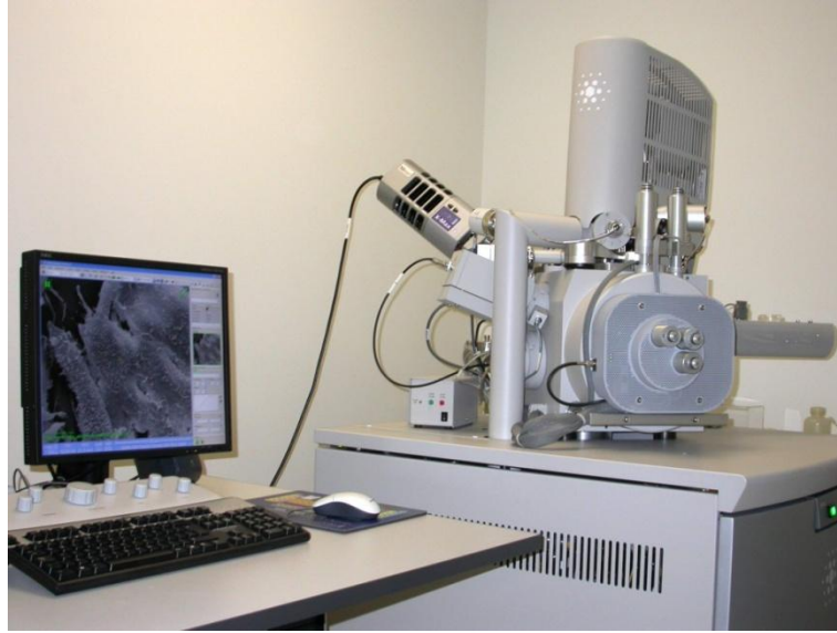
Şekil 5.9. FEI marka Quanta FEG 450 model SEM cihazı
