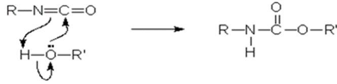
Şekil 3.2 İzosiyanat ve poliol arasında gerçekleşen üretan reaksiyonu
