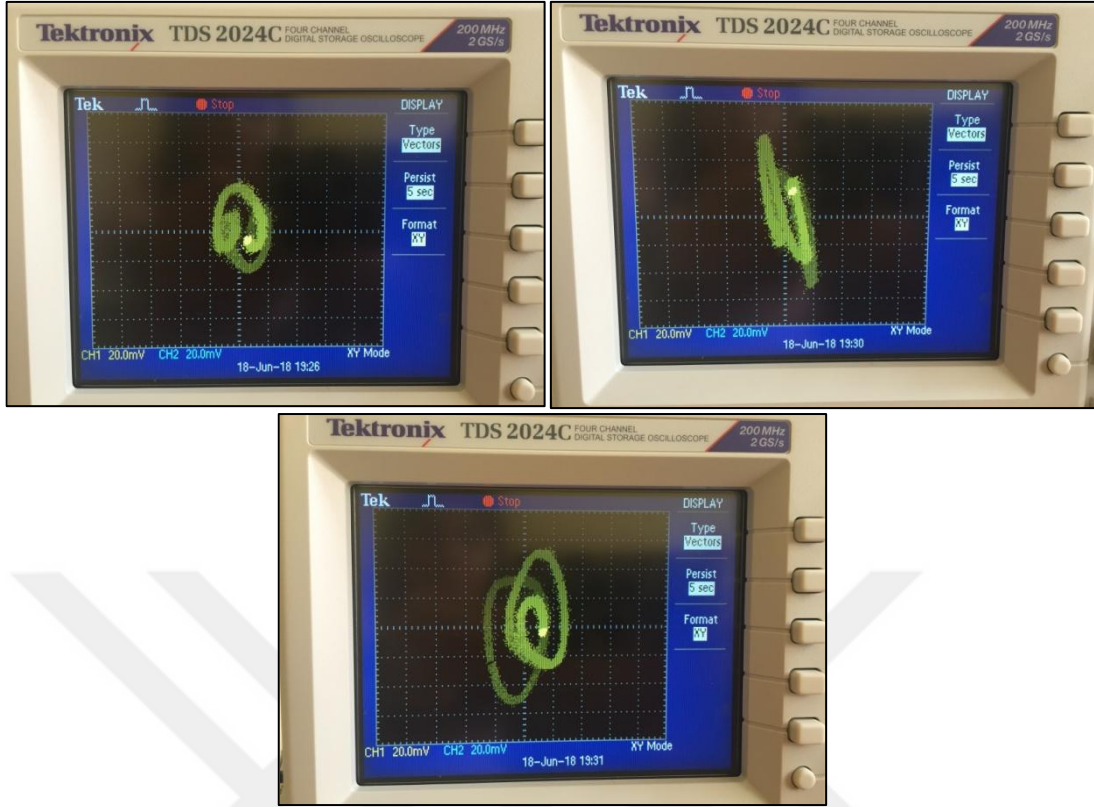
Şekil 5.55 Arneodo kaotik osilatörüne ait gerçek zamanlı 2D faz portreleri
