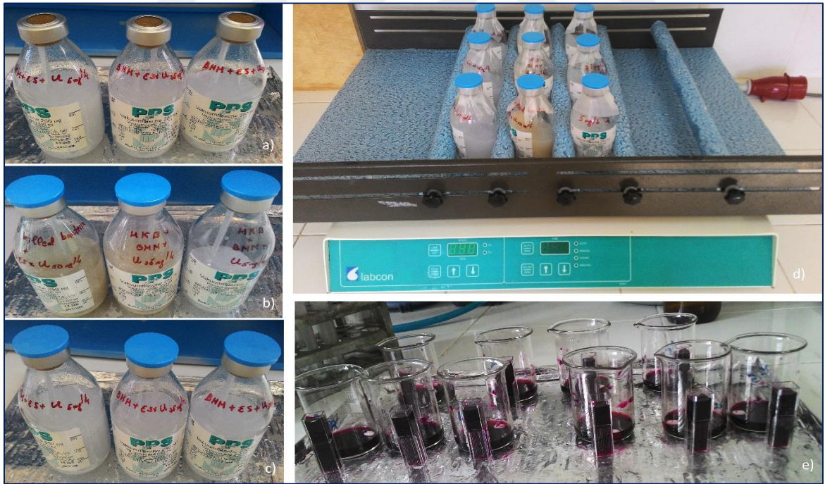
Şekil 5.2. Uranyuma Dayanıklı Karışık Kültür ile Sudaki Uranyumun Giderilmesinin Kesikli Reaktör Deneyi: a) BMM, elektron verici (E.V.) ve farklı konsantrasyonlarda (5mg/L, 25mg/L, 50mg/L) uranyum içeren çözeltiler, b) BMM+E.V.+U(5, 25, 50) + ısıyla öldürülmüş U.D.K.M. çözeltileri, c) BMM+E.V.+U(5, 25, 50) + canlı U.D.K.M. içeren çözeltiler, d) 120rpm hızında Labcon karıştırıcısında sürekli karıştırılarak deneyin yapılması, e) 'Arsenazo' yöntemiyle uranyum konsantrasyonunun spektrofotometrede ölçülmesi.
