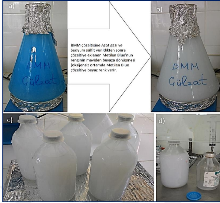
Şekil 5.1. Deney çözeltilerinin hazırlanması: a) ve b) oksijen indikatörü olarak Metilen Blue eklenen BMM çözeltisine Azot gazı ve Sodyum sülfid verilerek oksijensiz anaerobik çözelti elde edilmesi (a) oksijenli, b) oksijensiz), c) ve d) hazırlanan anaerobik çözeltileri serum şişelerinden Kesikli Reaktör olarak kullanılacak olan 250mL steril ve havasız vakum şişelerine şırınga ile aktarılması (c) serum şişelerindeki anaerobik BMM çözeltisi, d) Vakum şişesine BMM çözeltisinin aktarılması).
