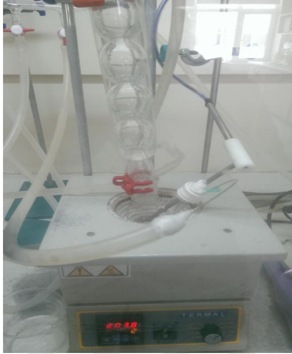
Şekil 3.2. CdSe eldesinde 2. Deney düzeneği
