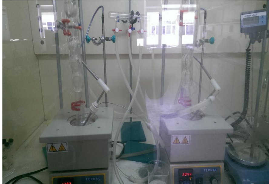
Şekil 3.3. CdSe yüksek sıcaklıkta eldesinin düzeneği
