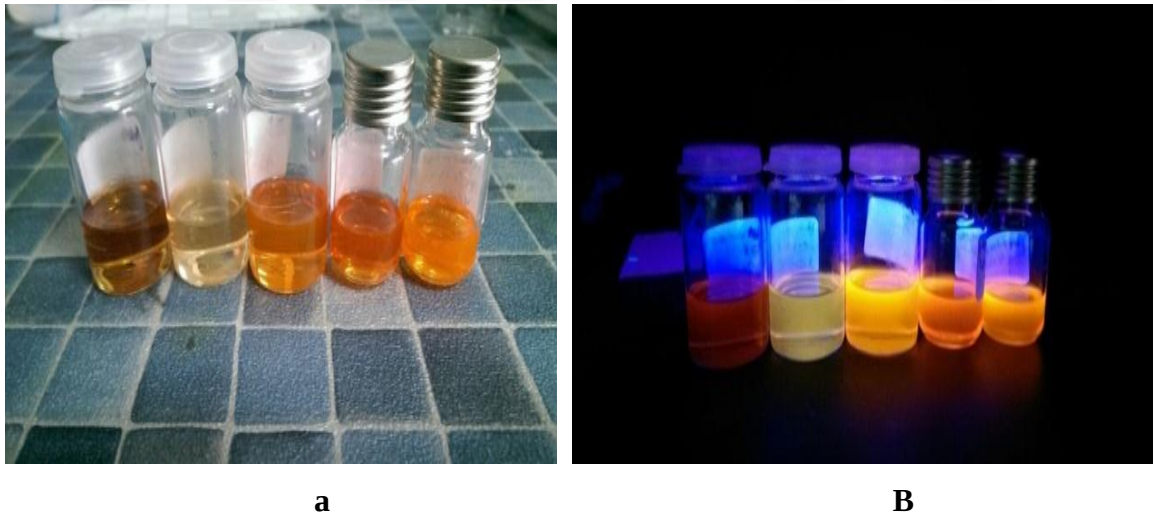
Şekil 4.1. CdSe nanokristal çözeltileri; a) Gün ışığında, b) UV lamba altındaki görüntüleri (soldan sağa doğru 5, 10, 20, 30, 40 sn’lerde reaksiyon ortamından alınan nanokristal çözeltileri)
