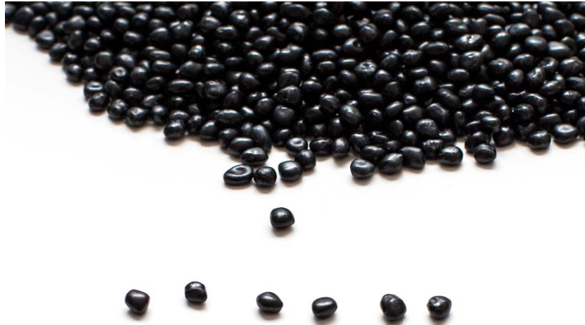
Şekil 3.2 (a) Polyester tekstil teleflerinden elde edilen granüller, (b) Polyester tekstil teleflerinden elde edilen granüllerin boyut görüntüsü
