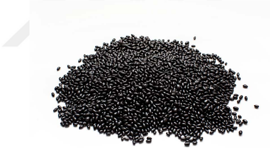
Şekil 3.4 Tekstil teleflerinden elde edilen granüllere %0,5'lik zincir uzatıcı eklenerek elde edilen granüllerin görüntüleri
