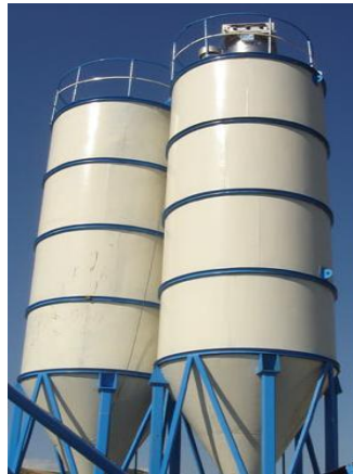
Şekil 2.15. Jet grout imento silosu (ınar, 2014)
