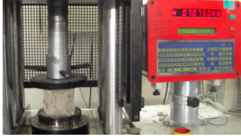
Şekil 4.3. Karot numuneler üzerinde serbest basınç deneyi yapılışı (Çınar, 2014)
