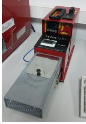
Şekil 3.10. Permetest Relatif Su Buharı Geçirgenliği Test Cihazı
