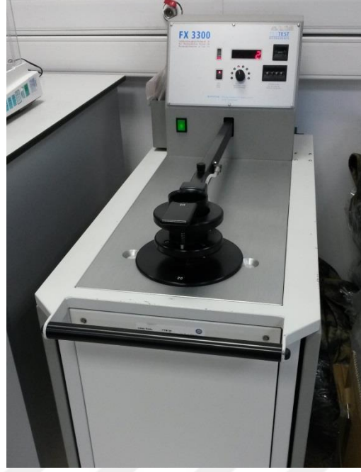
Şekil 3.9. 4. TEXTEST Instrumentes/FX3300 hava geçirgenliği test cihazı
