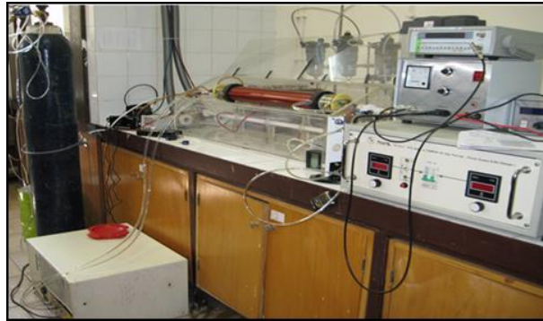
Şekil 3.4. Ozon gazı üretimi için tasarlanan deney düzeneği [5]
