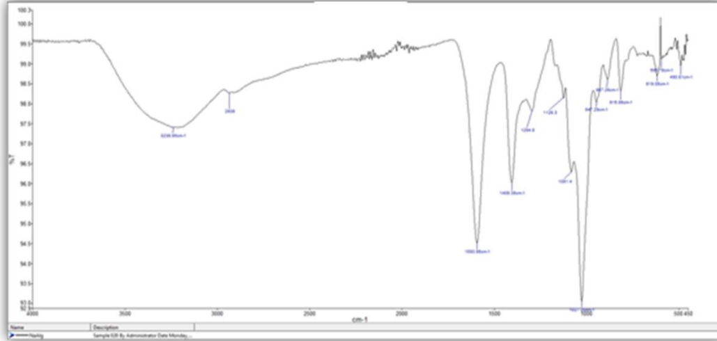
Şekil 4.1: Sodyum aljinata ait FTIR spektrumu
