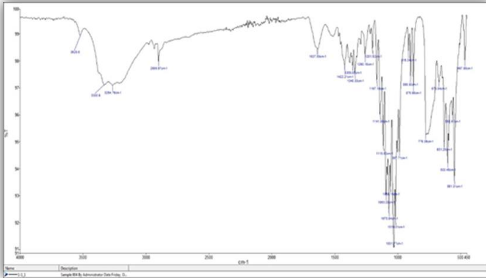
Şekil 4.2: Tripsin'e ait FTIR spektrumu
