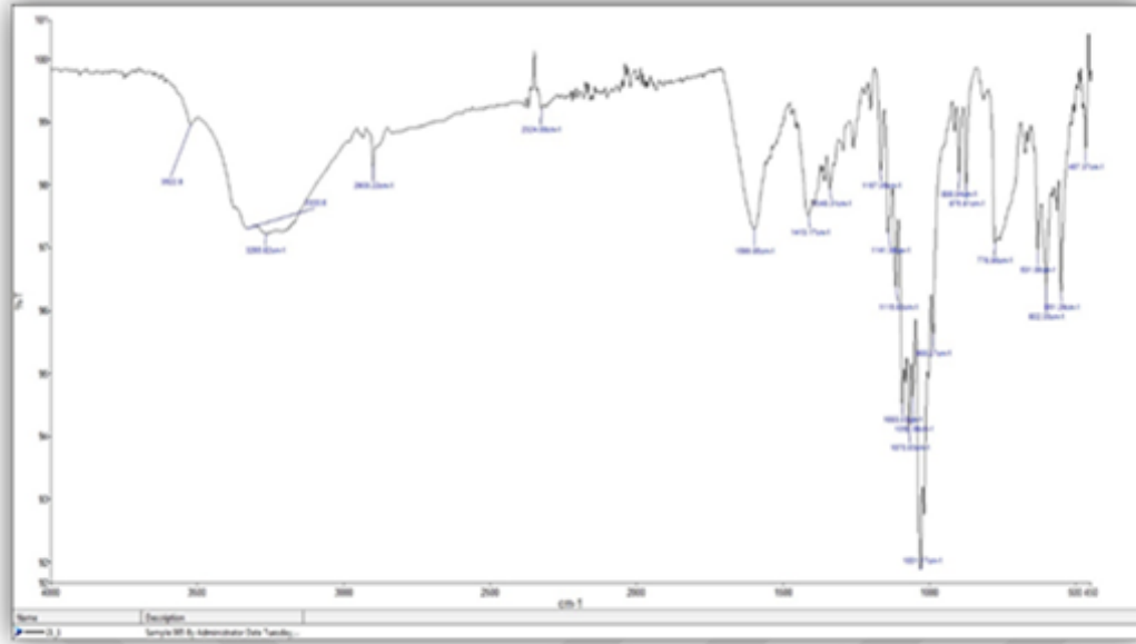
Şekil 4.3: Trypsin + Aljinat karışımına (1:1) ait FTIR spektrumu.
