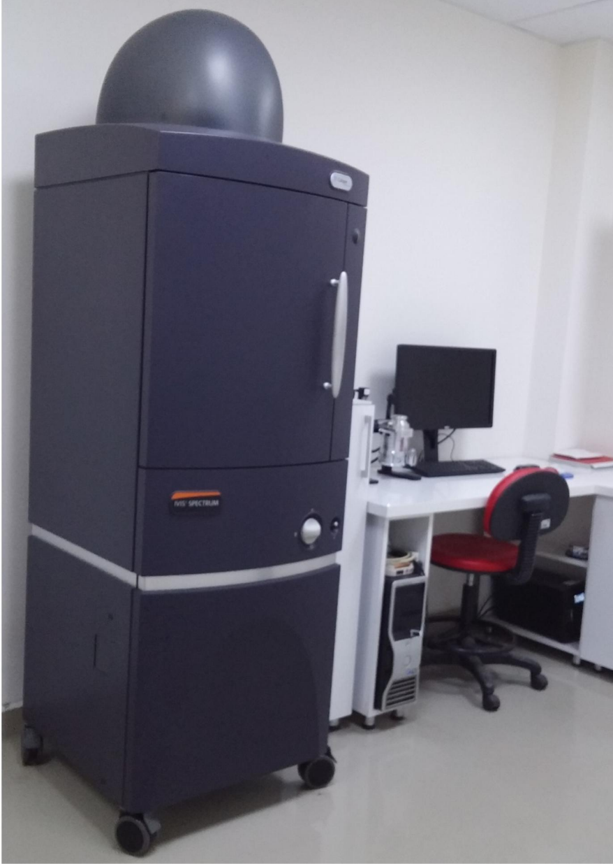
Şekil 2.7 Biyodağılım görüntülemelerinin elde edildiği IVIS Spektrum cihazı
