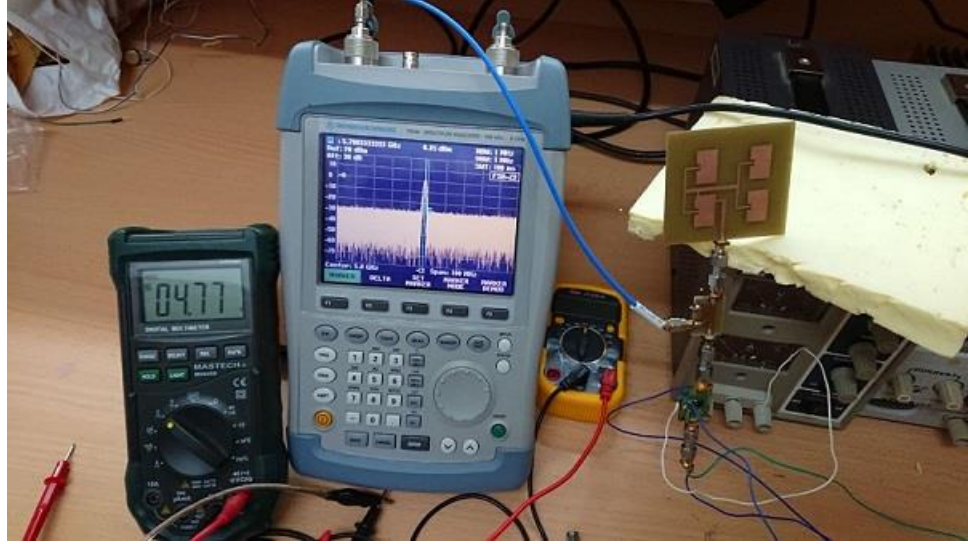
Şekil 5.13. Kuplörün çıkışından güç yükseltici girişine giden sinyalin ölçüm değeri
