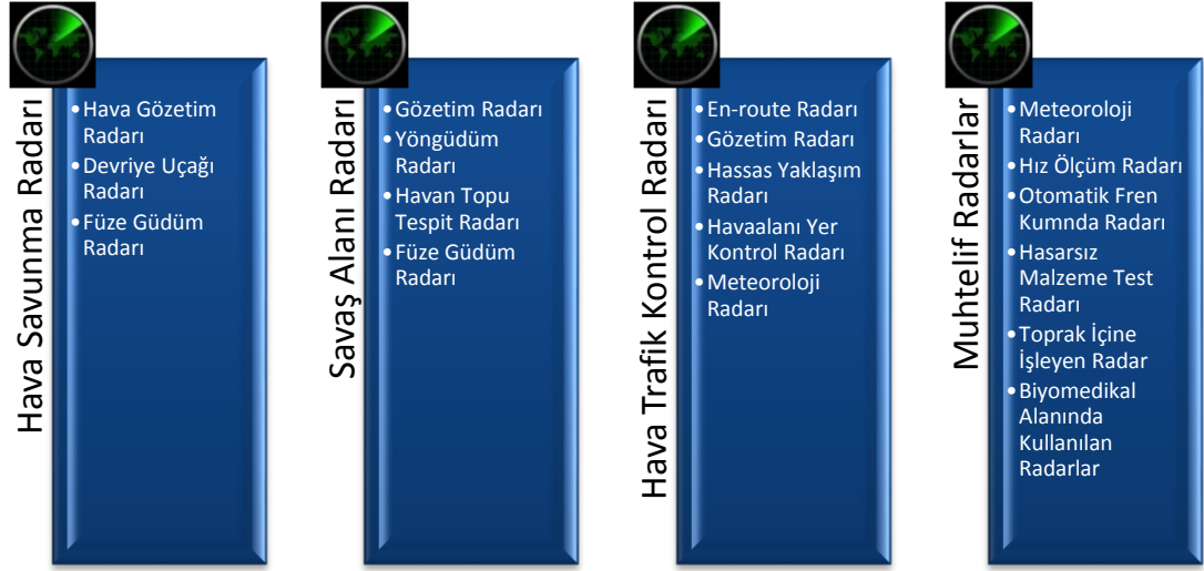
Şekil 3.1 Kullanım amaçlarına göre radarların sınıflandırılması
