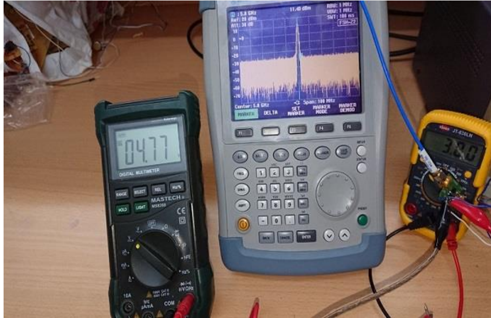
Şekil 5.10. VCO'ya verilen giriş gerilim değerleri ile çıkışından ölçülen sinyal gücü değeri
