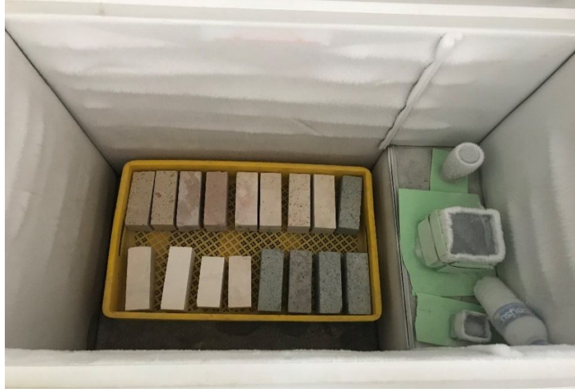
Şekil 3.19. Donma-çözülme deneyi numuneleri
