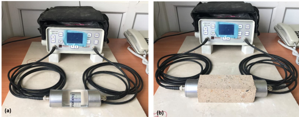
Şekil 3.18. a-b) Pundit UPV ölçüm cihazına ait görüntüler
