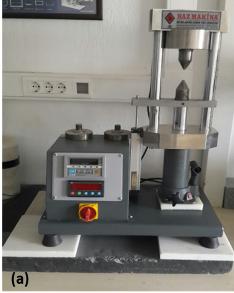
Şekil 3.27. a) Nokta yük dayanım indeksi tayini deney aleti ve b) Nokta yük dayanım indeksi tayini deney uygulaması
