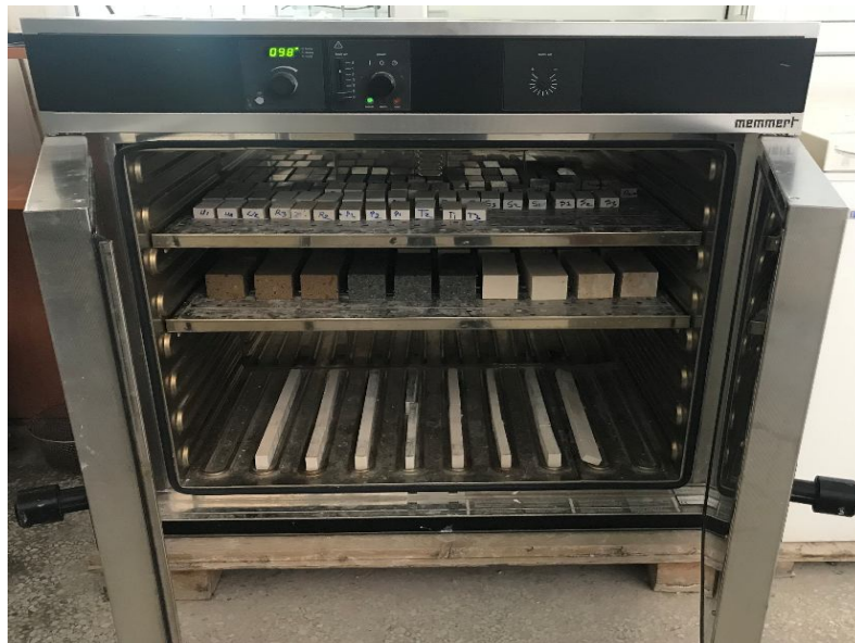
Şekil 3.20.Termal şok deneyi numuneleri
