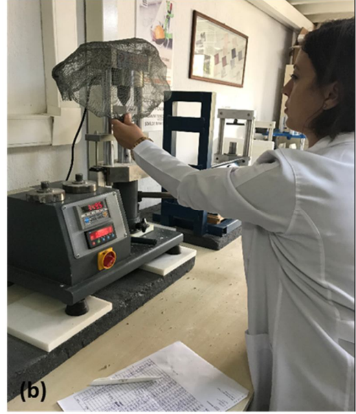
Şekil 3.27. a) Nokta yük dayanım indeksi tayini deney aleti ve b) Nokta yük dayanım indeksi tayini deney uygulaması
