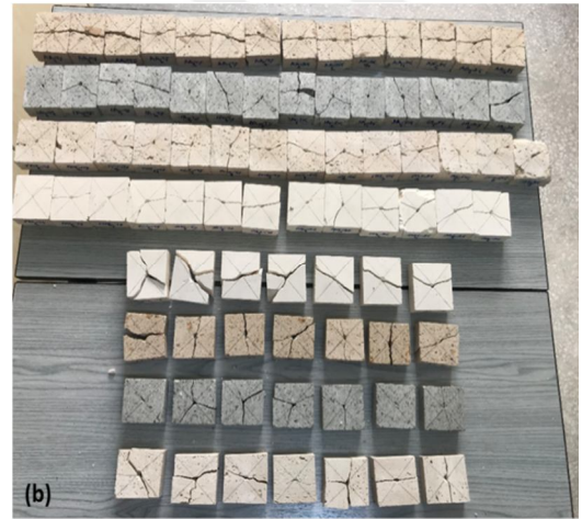
Şekil 3.28. Nokta yük deneyine tabi tutulmuş numunelere ait görüntüler a) Kırılmadan önce b) Kırıldıktan sonra
