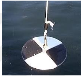
Şekil 3.7. Seki diski ile ölçüm uygulaması
