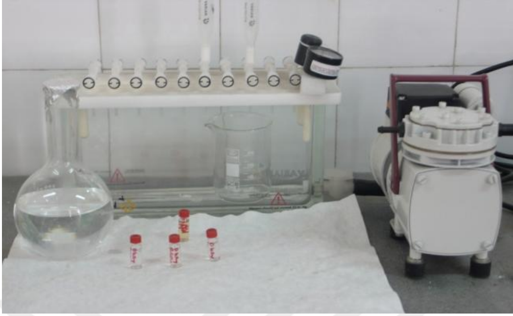
Şekil 3.6. Vakum manifold düzeneği ve C18 kartuşlar.
