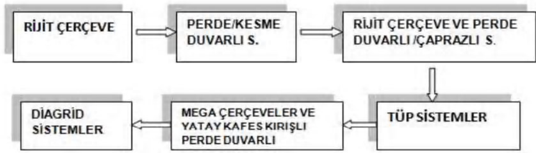
Şekil 2.6. Yüksek yapıların biçimlenmesinde temel olan strüktürel sistemlerin zamana bağlı gelişim şeması (Tuğrul, 2014'den uyarlanmıştır).
